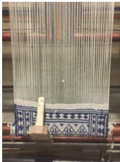
شکل ۷۹- جمع کردن زیلو بر روی تیر پایین
