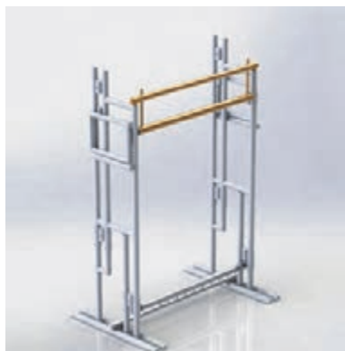
شکل ۵۹-قرار دادن مهار بالای جلو
