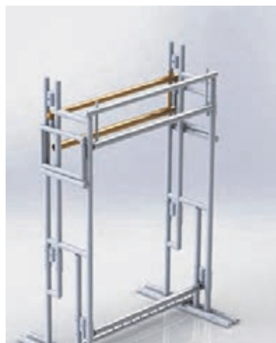
شکل ۶۰-قرار دادن مهار بالا
