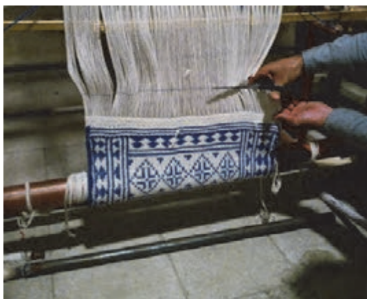
شکل ۸۳- چیدن یا برش دادن زیلو
