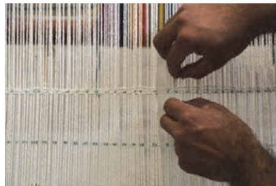
شکل ۷۲- مرتب کردن و تنظیم فاصله چله‌ها
