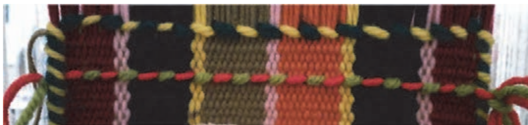
شکل ۹- سربندی انتهای بافت
