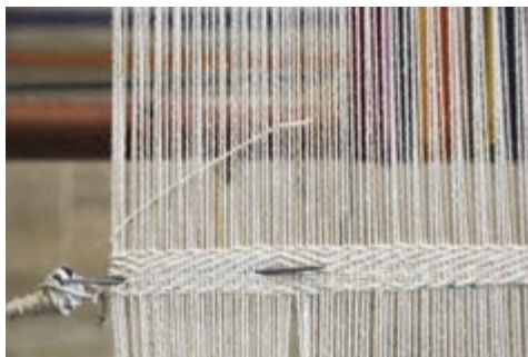
شکل ۷۳- اتمام بافت سرپر
