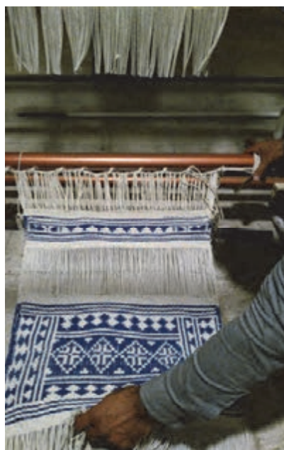
شکل ۸۶- آزاد کردن زیلو از تیر پایین
