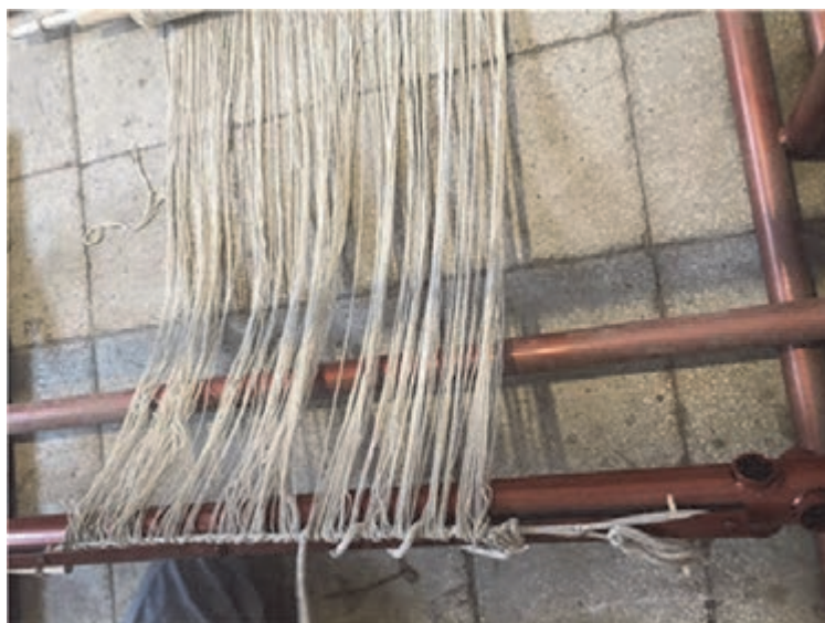
شکل ۴۲- ته دوزی کردن تارها
