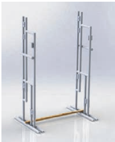
شکل ۵۷-قرار دادن مهار پایین
