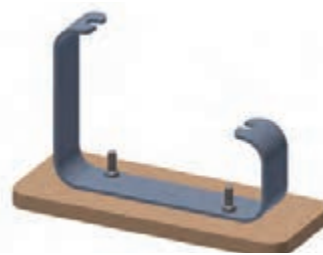
شکل ۳۹-۵. متصل کردن قطعه‌ها با پیچ و مهره
