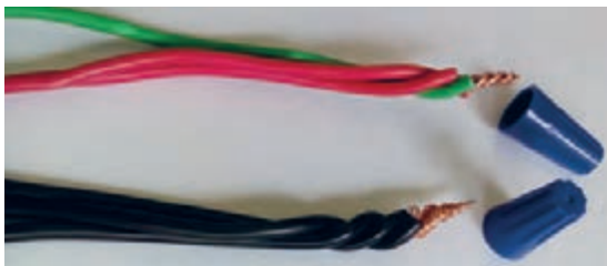
شکل ۴۴- آماده کردن سیم
