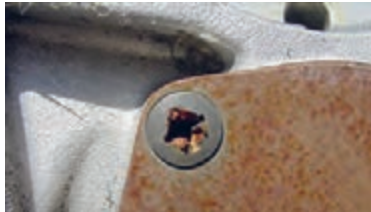
ب) استفاده ناصحیح از آچار پیچ گوشتی
