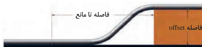
شکل ۳۵- هم‌راستا کردن امتداد لوله
