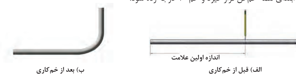
شکل ۳۶- روش تقریبی برای خم کاری
