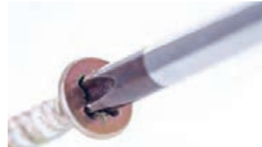
الف) استفاده صحیح از آچار پیچ گوشتی
