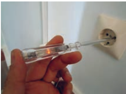
شکل ۴ - کاربرد صحیح فازمتر
