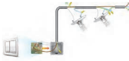
شکل ۲۷ - مدار کلید دوراهه (دابل)
