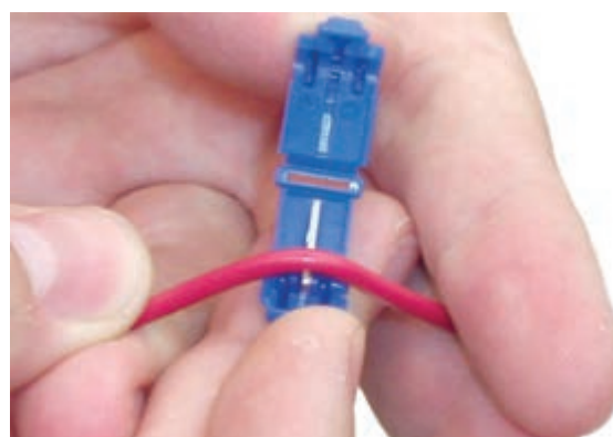
شکل ۳۵- اجزاء سرسیم انشعابی
