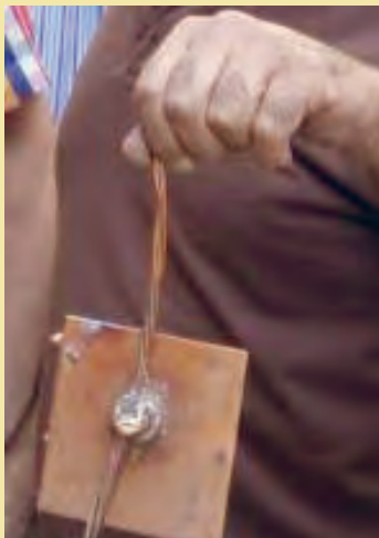
شکل ۹۷- جوش اگزوترمیک
