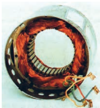
شکل ۷۰- سرسیم‌ها و سیم‌پیچی‌های موتور الکتریکی کولر آبی
