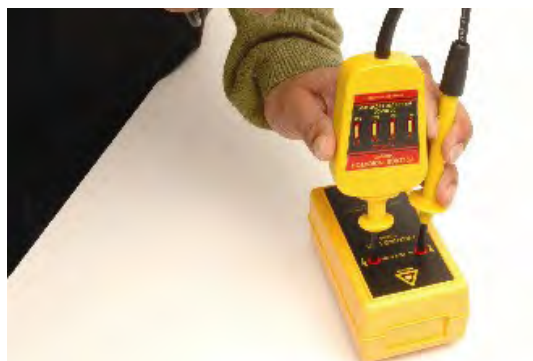
شکل ۵۲- نشانگر ولتاژ
