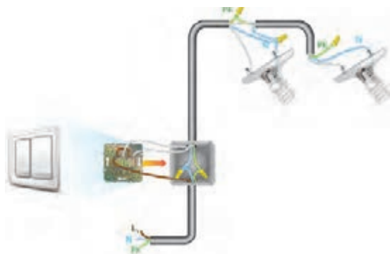
شکل ۲۷ - مدار کلید دوراهه (دابل)
