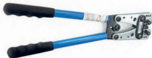
شکل ۵۸ - دستگاه پرس کابلشو
