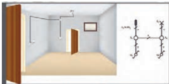
شکل ۳۶- کاربرد مدار تبدیل
