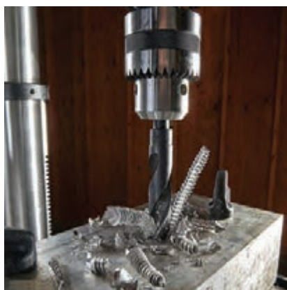
شکل ۳۰-۳- عملیات سوراخ کاری قبل از برقوکاری
