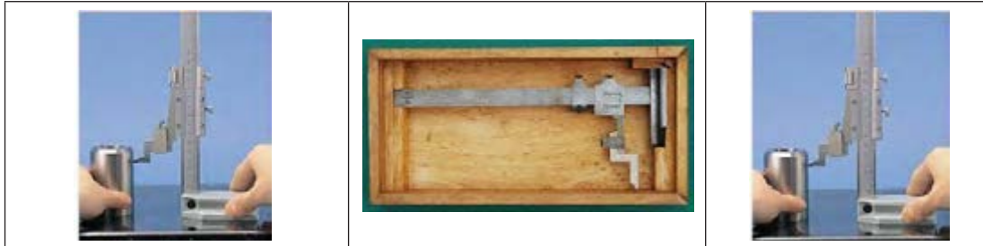
شکل ۳-۳- کولیس ارتفاع سنج
