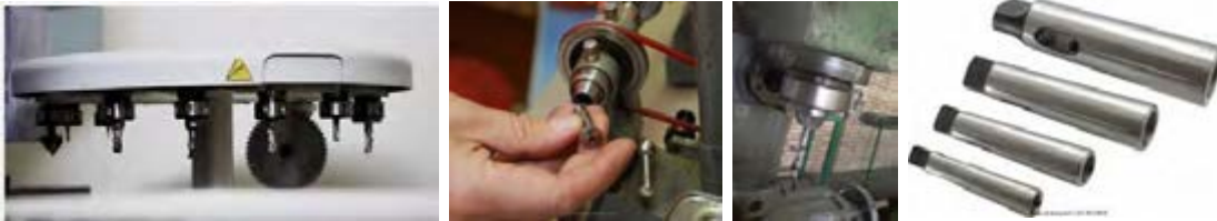
شکل ۴-۲- کاربرد سوراخ مخروطی در دستگاه‌های فرز
