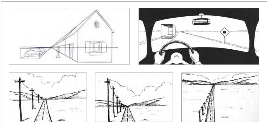
▲ تصویر ۶-۴- خط افق، خط جداکننده بین زمین و آسمان است که با توجه به ارتفاع ناظر تغییر می‌کند.
