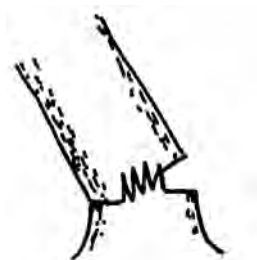
شکل ۲-۱۵- برای قطع درخت ابتدا عمل زیر برش مطابق شکل انجام می شود.
