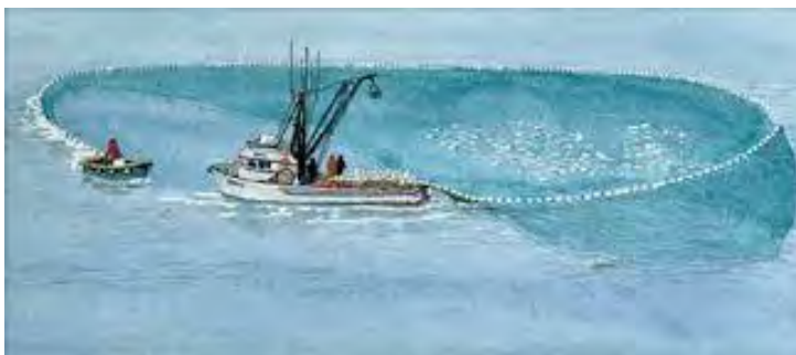
شکل ۶۴- نگهداری سر تور توسط قایق کمکی (اسکیف) در عملیات تور ریزی به روش پورس سینر
