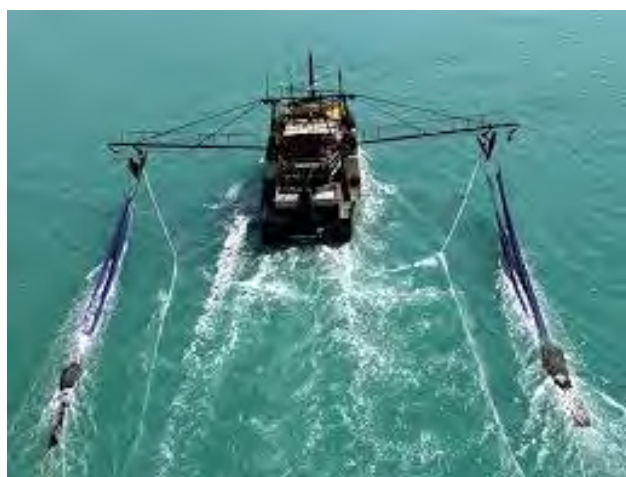
شکل ۵۳- تصویر عملیات توراندازی توسط یک کشتی ماهیگیری ترالردو بازویی از نمای پشت
