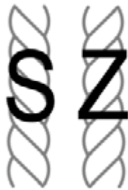
شکل ۲- جهت تاب در نخ‌های ماهیگیری و انواع طناب‌ها
