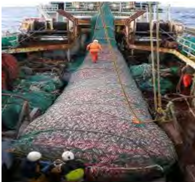
شکل ۵۱- خاتمه عملیات تورکشی و استقرار تور ترال بر روی عرشه در یک کشتی ترال پاشنه کش
