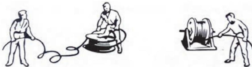
شکل ۱۹- اصول باز کردن حلقه طناب سیمی با قرقره
