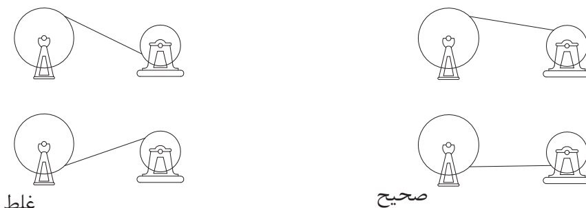
شکل ۲۰- اصول پیچاندن طناب‌های سیمی از روی یک قرقره به قرقره دیگر
