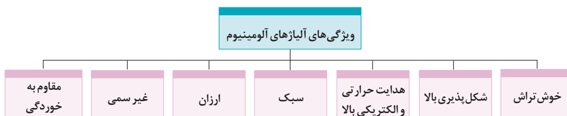
شکل ۱۶- ویژگی‌های آلیاژهای آلومینیوم
