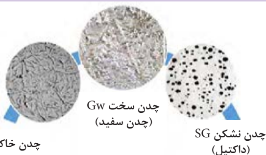
شکل ۱۴- انواع چدن و شکل متالوگرافی آنها
