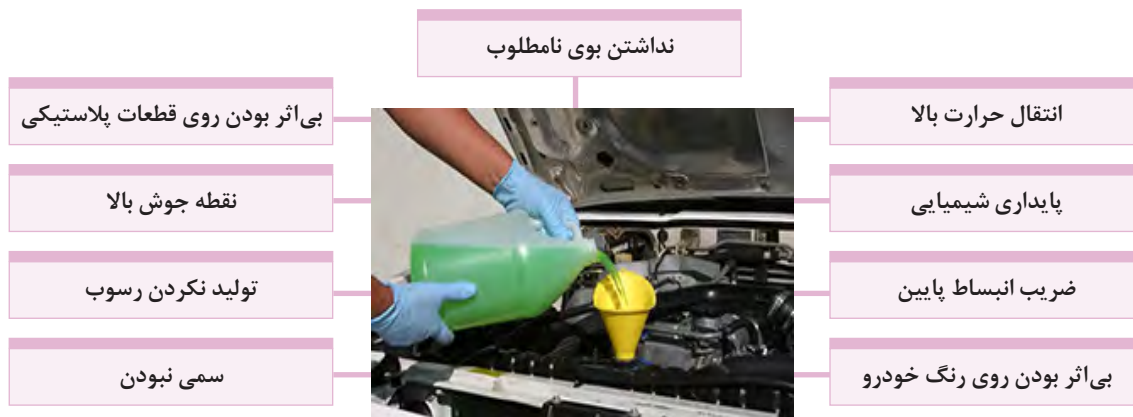
شکل ۴۷- ویژگی های مایع خنک کننده
