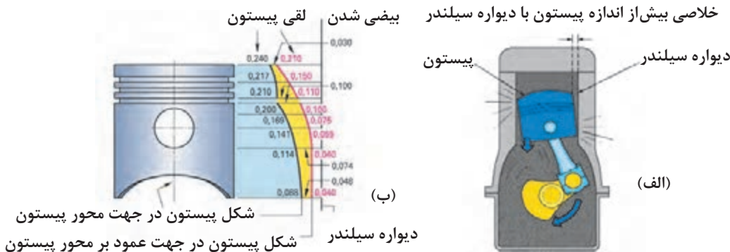
شکل ۲۸-۲- لقی پیستون در یک پیستون بیضی شکل
