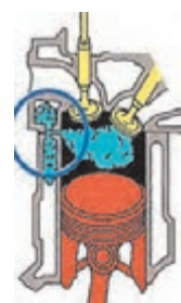
شکل ۲-۹۳- نشستی از محل‌های گوناگون بوش سیلندر و واشر سرسیلندر و بالای بوش
