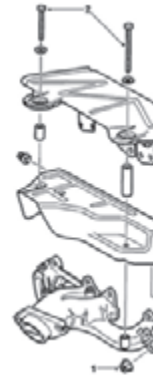
ث) نقشه انفجاری سپرهای حرارتی و مانیفولد دود
