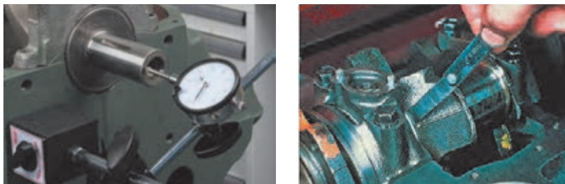
شکل ۲-۱۳۸- اندازه‌گیری لقی طولی میل‌لنگ
