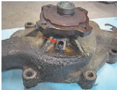
ت) شکستگی پایه‌ها
