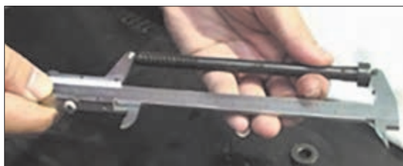
شکل ۹۰-۱- اندازه‌گیری پیچ سرسیلندر
