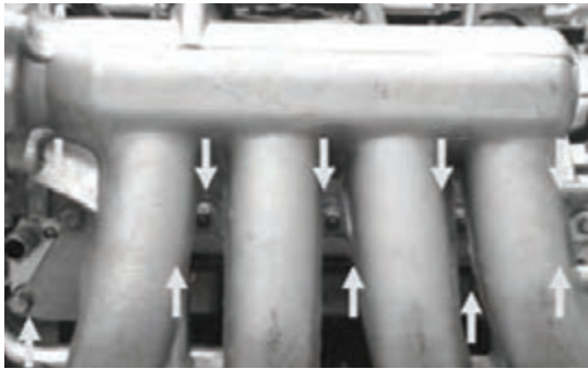
ب) باز کردن پیچ‌های مانیفولد ورودی
