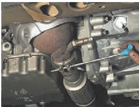
ب) جای بسته شدن حصیری اگزوز روی خودرو
