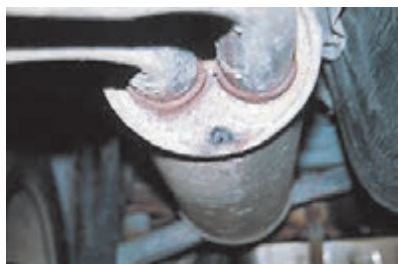
ب) تصویر سوراخ شدن کاتالیست
