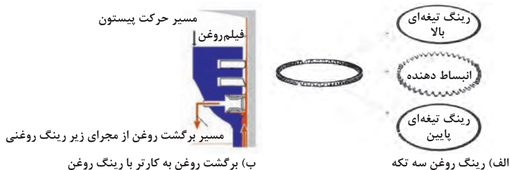
شکل ۲-۴۶- عملکرد رینگ روغن سه تکه
