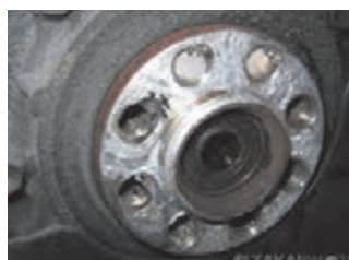
(الف) خرابی جای پیچ فلاپیول روی میل‌لنگ
