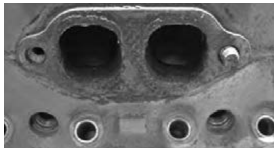
(الف) بریدن پیچ اتصال مانیفولد دود داخل سرسیلندر
