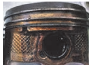
پ) کربن‌گرفتگی بیش از اندازه رینگ‌ها
