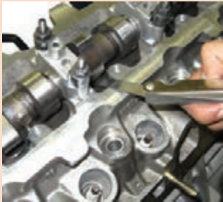
شکل ۶۲-۱- روش فیلر زدن
