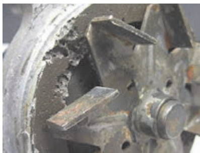
ج) خرابی بلبرینگ و خوردگی داخلی
