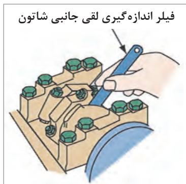
شکل ۱۳۶-۲- اندازه گیری لقی طولی
