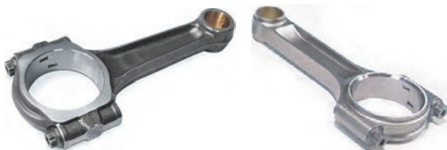
الف) شاتون با روش تولید آهنگری (فرم دهی گرم) ب) شاتون با روش تولید ریخته‌گری و بوش گژن پین شکل ۲-۵۸- شاتون آهنگری و ریخته‌گری شده
