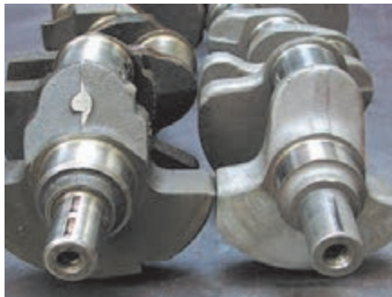
شکل ۶۷-۲- مقایسه ظاهری بین میل لنگ‌های تولید شده با روش ریخته‌گری و آهن‌گری
