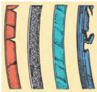
شکل ۲-۵- انواع خرابی‌های تسمه
