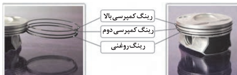
شکل ۴۵-۲ پیستون سبک با ارتفاع کم با دو رینگ کمپرسی و یک رینگ روغنی
