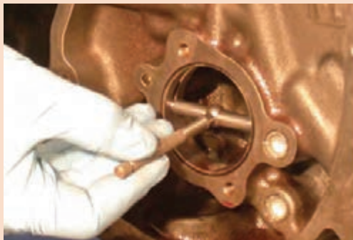
شکل ۷۵-۱- بررسی لقی در یاتاقان یکپارچه
