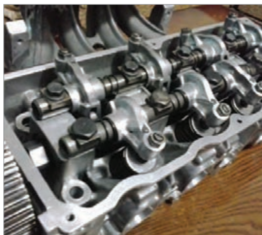
ت) مجموعه اسبک غلتکی دارای پیچ و مهره تنظیم (موتور OHV-OHC)
