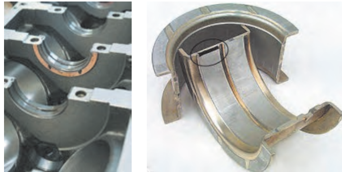
الف) بغل یاتاقانی یکپارچه با یاتاقان ثابت ب) بغل یاتاقانی جدا
