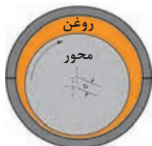
الف) لایه روغن بین یاتاقان و میل‌لنگ
