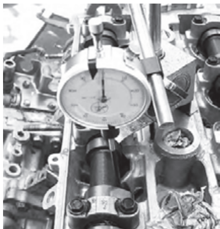
شکل ۱-۷۷- اندازه‌گیری ارتفاع خیز سوپاپ
