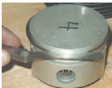
ب) کنترل خلاصی رینگ و پیستون نو
