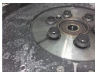
(ب) شل شدن پیچ‌های فلاپیول
