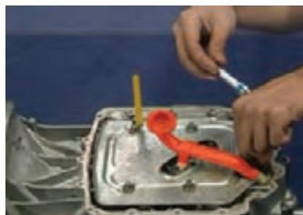
ب) بازکردن صافی روغن ورودی به پمپ
