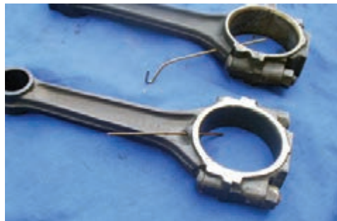
الف) سوراخ روغن پاش به کف پیستون و روغن کاری بوش گژن پین ب) سوراخ روغن پاش به دیواره سیلندر شاتون با مجرای روغن کاری شکل ۲-۶۳- شاتون
