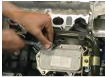
ح) بستن خنک‌کن روغن روی موتور
