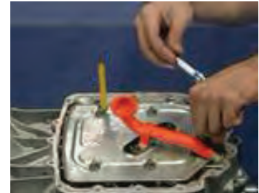
ت) بستن صافی روغن و متعلقات آن روی موتور
