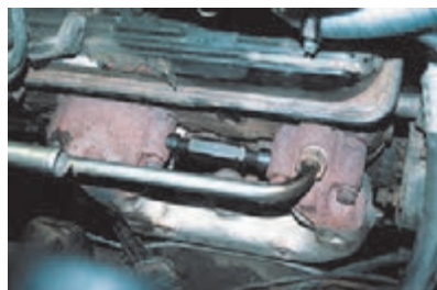
الف) تصویر نشتی دود بین مانیفولد و سرسیلندر
