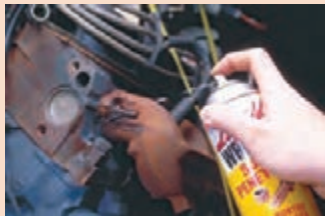
شکل ۵۳-۱- استفاده از اسپری ضد قفل
