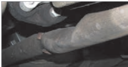
ث) بازدید چشمی لوله اگزوز از نظر خم شدن و تغییر شکل دادن
