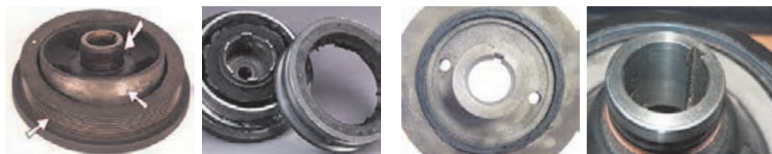
الف) پاره شدن لاستیک میان دو حلقه
