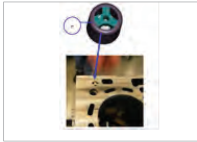
ب) بستن سوپاپ یک طرفه روغن روی بلوک یا سرسیلندر
