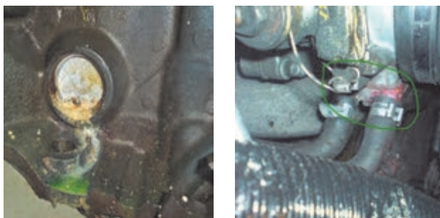
شکل ۱۵-۲ الف) نشستی از لوله‌ها و پولک اطراف سیلندر
