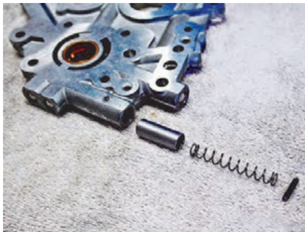
شکل ۴-۶- محل قرارگیری سوپاپ کنترل فشار
