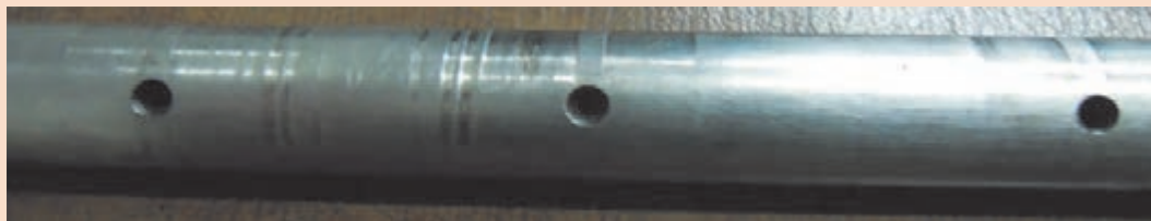
شکل ۸۹-۱- کانال روغن در میل اسبک
