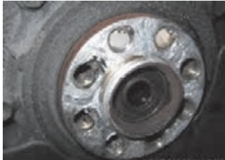
شکل ۲-۱۱۶- خرابی رزوه سر میل لنگ
