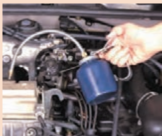
شکل ۲۴-۱- روش کمپرس‌گیری تر
