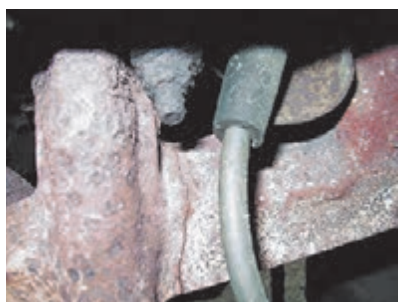
ت) تصویر شکستگی مانیفولد
