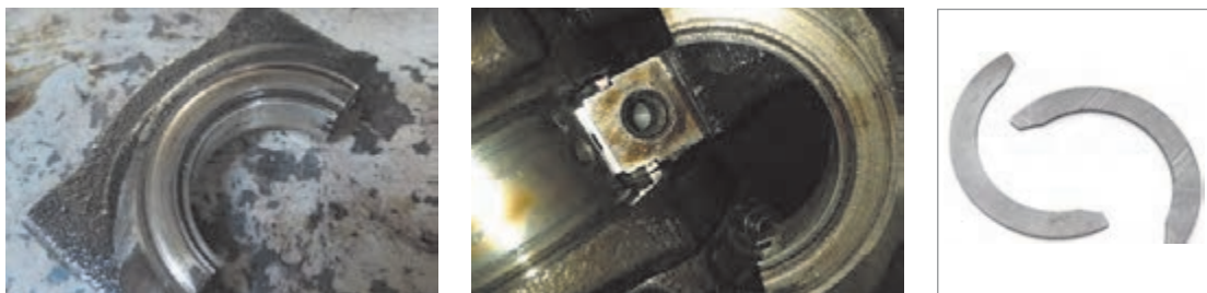
شکل ۲-۱۳۷- خرابی بغل یاتاقانی میل‌لنگ
