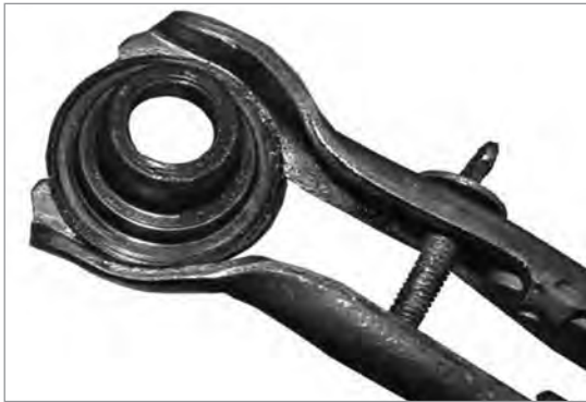
شکل ۱-۶۵- تنظیم گیره نگهدارنده بشقابک سوپاپ در فتر سوپاپ جمع کن
