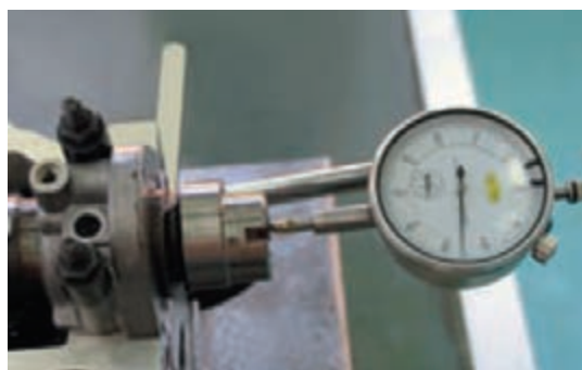
شکل ۸۶-۱- بررسی لقی طولی میل سوپاپ
