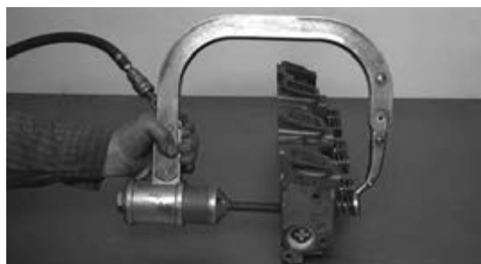
الف) استفاده از فنر سوپاپ جمع کن پنوماتیکی
