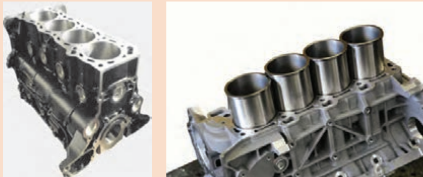
شکل ۲-۲۴- بلوکه با سیلندر یکپارچه و بوش جدا شدنی
