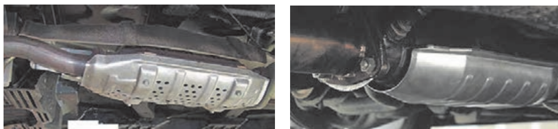
شکل ۲۵-۳ جای بسته شدن سپر حرارتی در سیستم اگزوز
