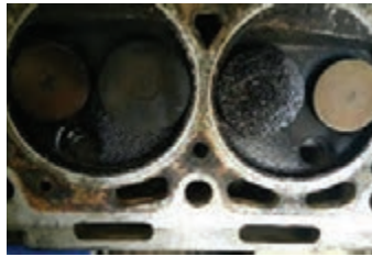
ث) ورود روغن به داخل سیلندر از ناحیه راهنمای سوپاپ ورودی
