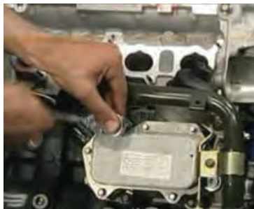
پ) بازکردن پیچ های خنک کن
