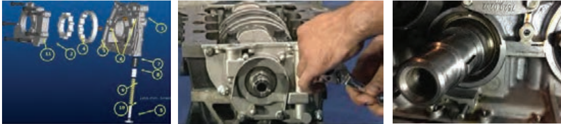
پ) بازکردن اجزای پمپ و سوپاپ تنظیم فشار
