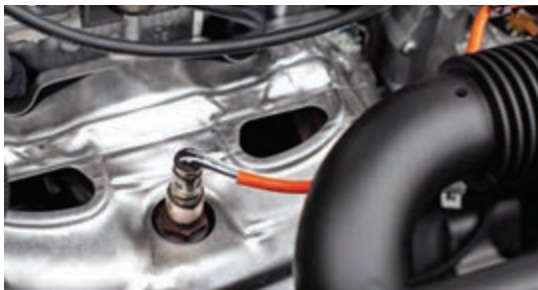
ب) جای بسته شدن حسگر اکسیژن
