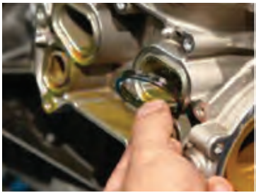
ج) بستن اورینگ‌ها و واشرهای خنک‌کن روغن
