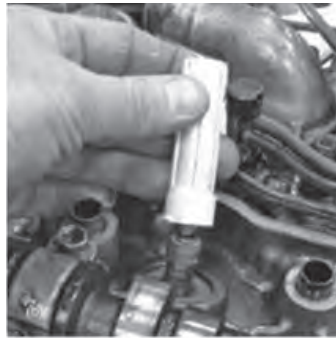
ب) روش جازدن کاسه نمد گاید راهنمای سوپاپ
