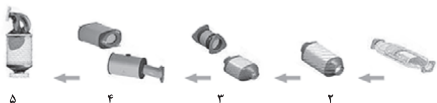
شکل ۱۲-۳- روند تکاملی مبدل های کاتالیستی
