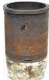
شکل ۲-۹۳- نشستی از محل‌های گوناگون بوش سیلندر و واشر سرسیلندر و بالای بوش
