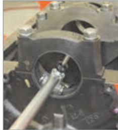
مرحله ۱-ب: کالیبره کردن ساعت در داخل محفظه یاتاقان ثابت
