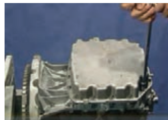
الف) بازکردن پیچ های کارتر
