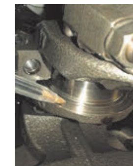
شکل ۲-۱۱۲- بررسی سایش جانبی میل لنگ
