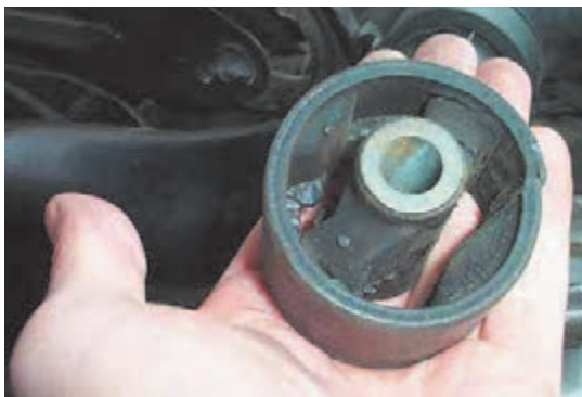
شکل ۲-۱۳ - پارگی دسته موتور
