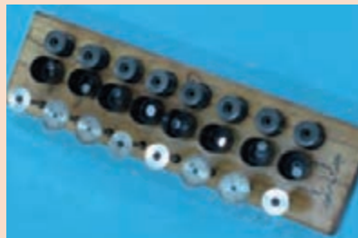
الف) حفظ ترتیب تایپیت ها و شیم های سوپاپ
