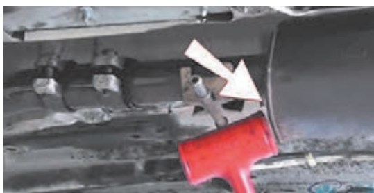
ح) بررسی اجزای داخلی کاتالیست به کمک چکش لاستیکی
