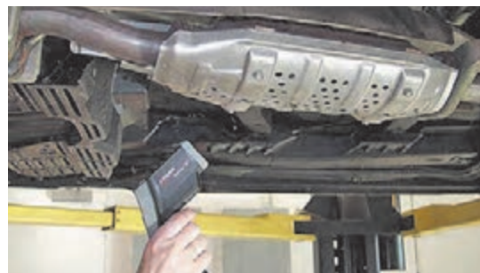
الف) برای بررسی دمای کاتالیزور با دماسنج، خودرو باید روی جک بالا برده شود و به دمای نرمال رسیده باشد.
