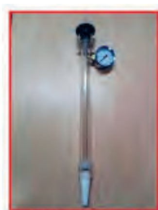
تانسیومتر آنالوگ مدل آب ۴۵ سانتی متری
