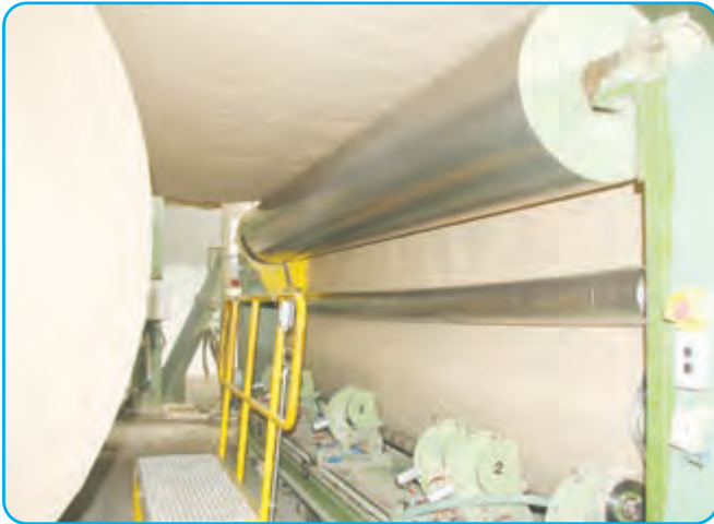
غلتک آهنی برای صاف کردن خمیر کاغذ
