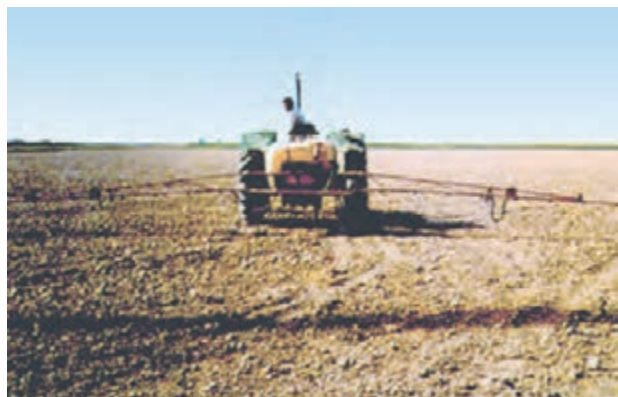
شکل ۱۲-۲. پخش علف کش با استفاده از سمپاش تراکتوری
