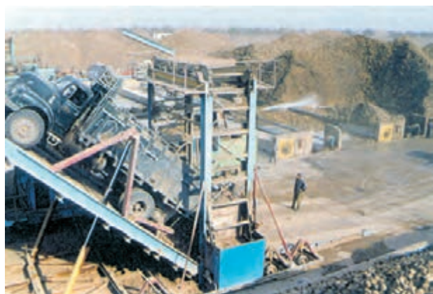
شکل ۱-۶- تخلیه چغندر در ابتدای خط کارخانه
