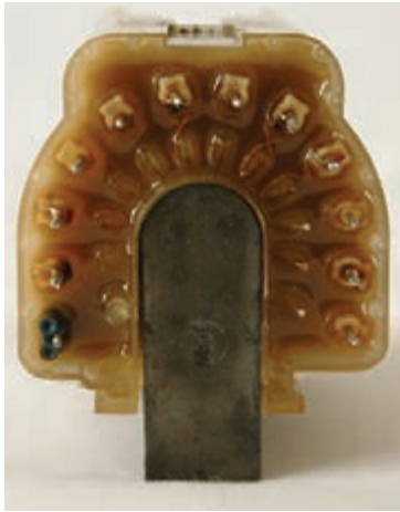
شکل ۱۳۴-۱- شکل پایه‌های TR526
