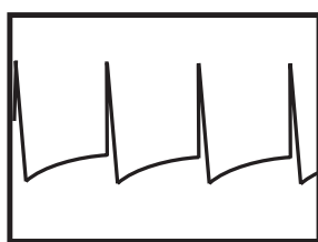
شکل ۱-۱۰۱- تهیهی ولتاژ L' از ترانس سطر
