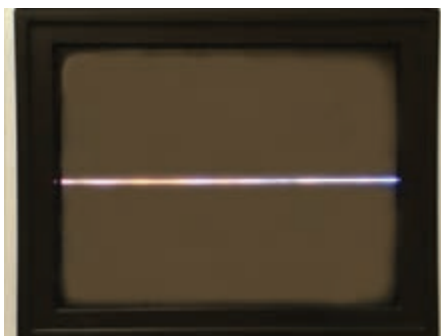
شکل ۲-۴۰ نوسان ساز عمودی از کار افتاده است.
