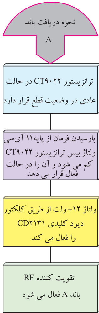
شکل ۶۶-۲- مسیر ارتباط ولتاژ ۱۲+ ولت به مدار هماهنگ و تقویت کننده باند A
