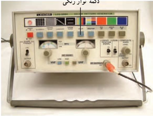
شکل ۲-۱۷۳- دگمه نوار رنگی روی پترن ژنراتور
