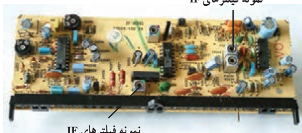
شکل ۲-۱۶۵- نمونه فیلترهای IF که نباید هسته‌ی آن‌ها تغییر داده شود.
