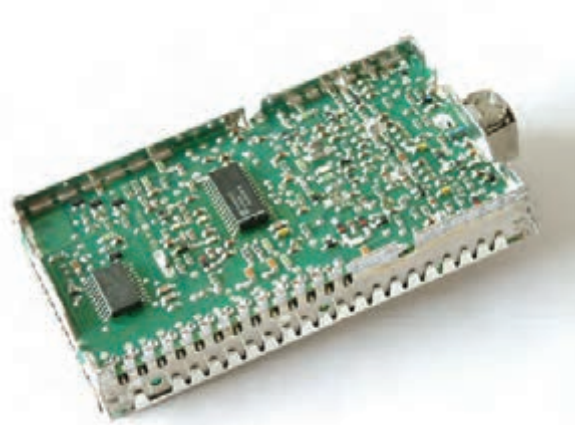
شکل ۲۱-۲- قطعات SMD روی برد تیونر
