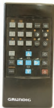
شکل ۳-۲۱- کلیدهای کنترل از راه دور
