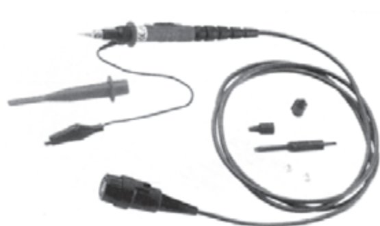
شکل ۱-۱۳۸- پراب با ضریب \times 10 برای اندازه گیری ولتاژ بالا
