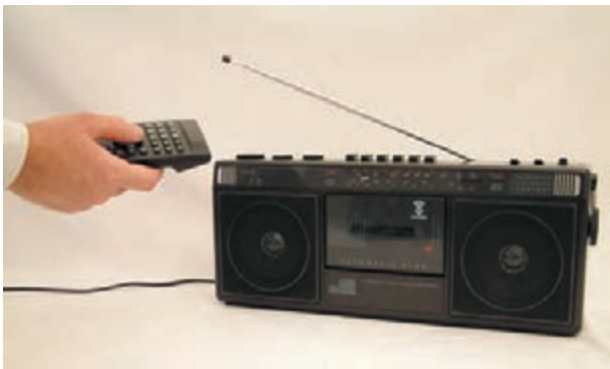
شکل ۳-۴۸- تست کنترل از راه دور توسط رادیو
