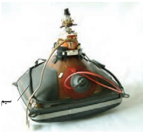
شکل ۲۰۰-۱- محل قرار گرفتن سیم پیچ مغناطیس زدا
