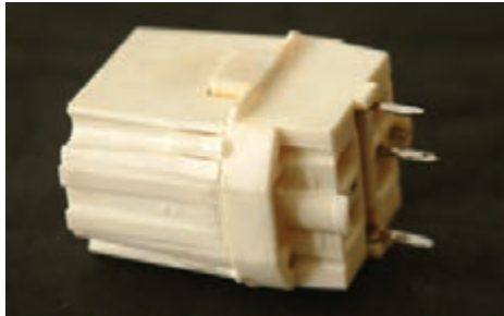
شکل ۱-۲۰۲- شکل ظاهری مقاومت R_{609} که یک PTC است.
