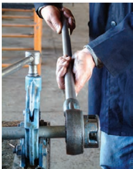
شکل ۴-۵۰- باز کردن حدیده از لوله
