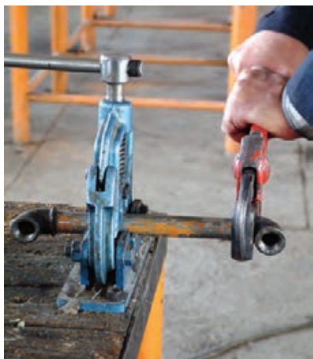
شکل ۵-۱۳۲- سیفت کردن فیتینگ‌ها به لوله‌ها و تکمیل مدار باز
