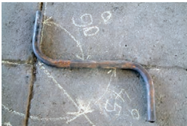
شکل ۳-۴۱- عدم دویدگی لوله‌ی دو خم
