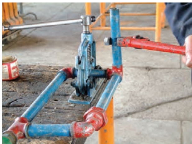
شکل ۱۶۲-۵- بستن لوله‌ی عمود بر مدار بر روی سهراهی کنج
