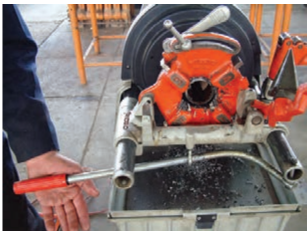
شکل ۴-۹۸- کشیدن اهرم به عقب پس از حدیده‌کاری
