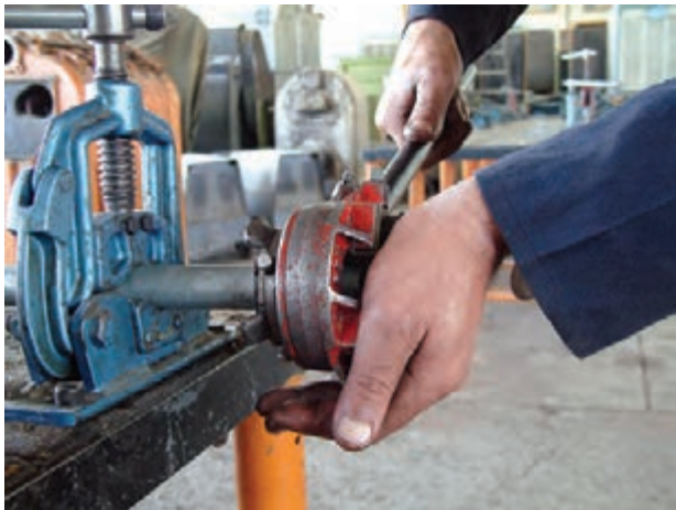
شکل ۴-۳۳- درگیر نمودن پارچه‌های حدیده با لوله
