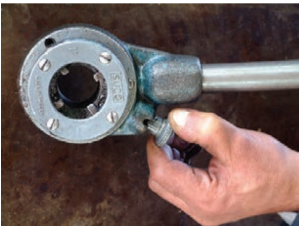
شکل ۴-۴۳- خارج کردن ضامن از شیار
