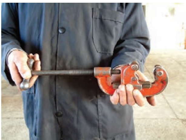
شکل ۱-۵۴- باز کردن دهانه‌ی لوله‌بر
