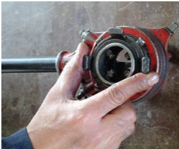
شکل ۴-۲۱- فلکه‌ی چهار نظام حدیده‌ی دستی دو پارچه
