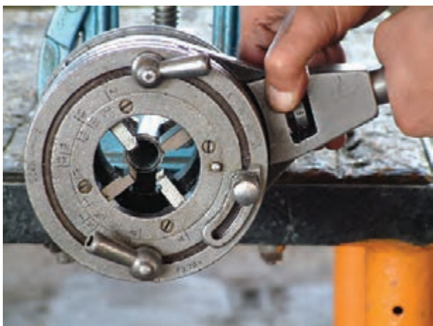
شکل ۴-۵۶- قرار دادن ضامن در حالت F
