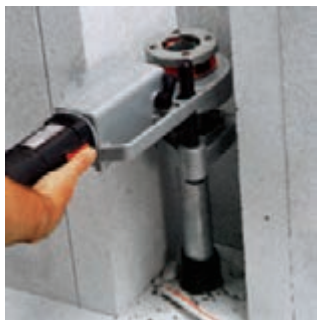
شکل ۴-۱۰۵ - طرز استفاده از حدیده
