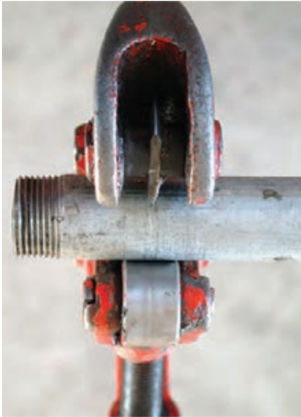
شکل ۹۶-۵- استفاده‌ی غلط از لوله‌بر با تیغه‌ی شکسته
