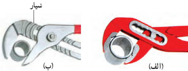
شکل ۵-۷۰- سوراخ‌ها و شیارهای متعدد آچارهای کلاغی
