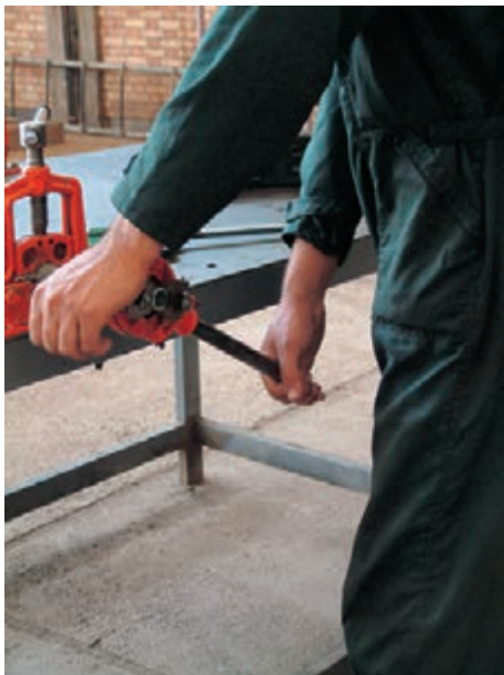
شکل ۴-۱۱۲- حدیده‌ی متناسب با قطر لوله
