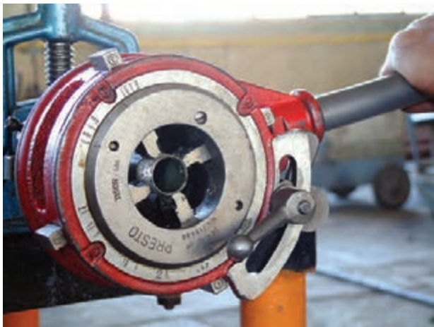
شکل ۱۲۴-۴- عمل حدیده کاری تا عبور پارچه‌ها از لبه‌ی لوله
