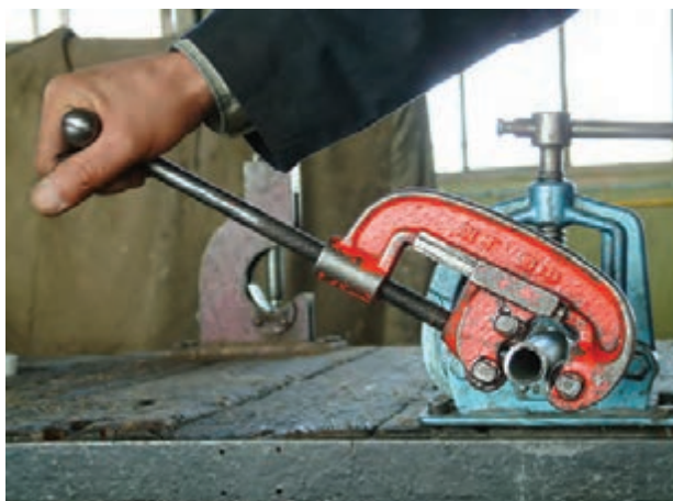
شکل ۱-۲۰- بریدن لوله‌ی فولادی به وسیله‌ی لوله‌بر یک تیغه‌ی یک‌دسته
