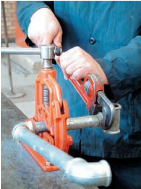
شکل ۱۰۳-۵- نحوه‌ی صحیح سفت کردن فیتینگ به لوله
