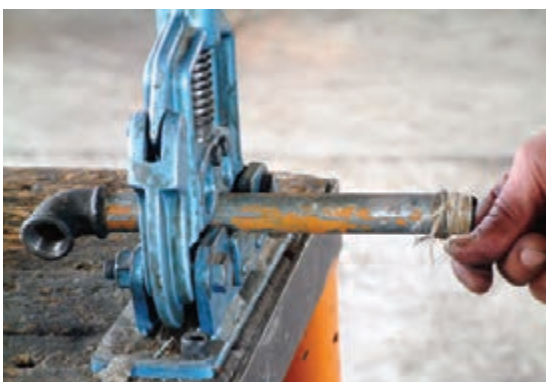
شكل ۵-۱۵۳- خمير و كنف كردن سردنده‌ی بعدی
