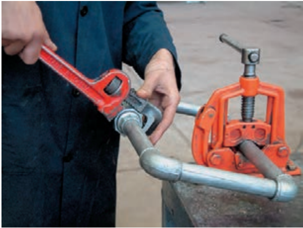
شکل ۱۰۶-۵- نحوه‌ی غلط سفت کردن مهره ماسوره
