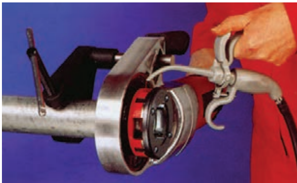
شکل ۴-۱۰۸- استفاده از روغن‌دان در جریان لوله‌کشی
