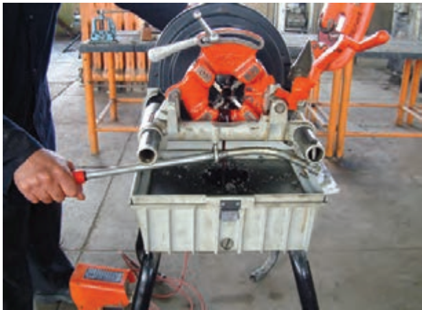
شکل ۱۳۳-۴- عمل حدیده کاری لوله
