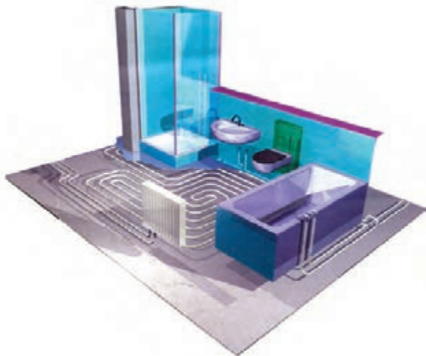
شکل ۵-۱۱- یکی از انواع لوله‌های پلیمری مورد استفاده در سیستم گرمایی و بهداشتی ساختمان
