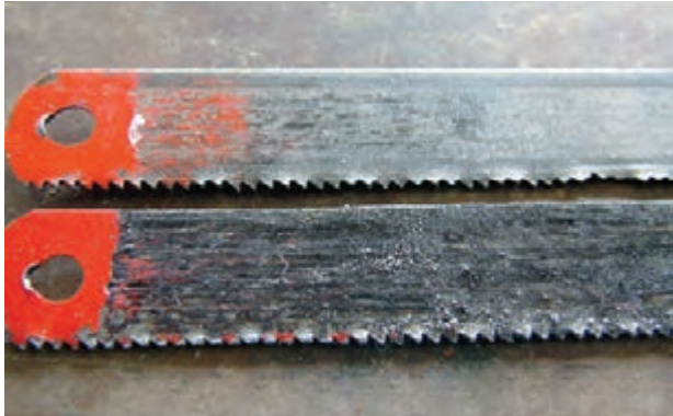
شکل ۱-۴۷- تیغه اره‌های دندان‌ها شکسته شده
