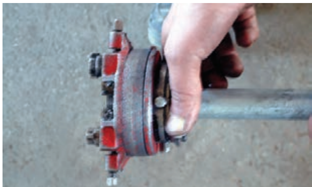
شکل ۱۲۴-۵- باز کردن فلکهای چهار نظام حدیده
