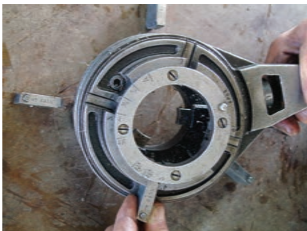
شکل ۴-۵۹- خارج کردن پارچه‌ها از حدیده
