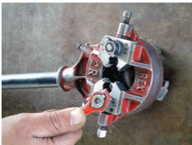
شکل ۴-۲۸- سفت کردن مهره به وسیله‌ی آچار حدیده
