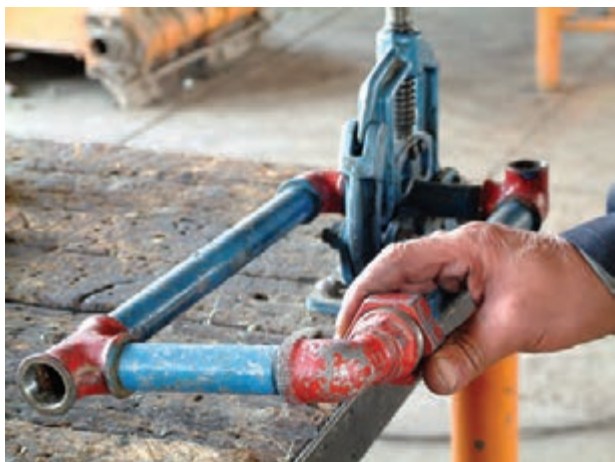
شکل ۵-۱۶۰- بستن مهره ماسوره به وسیله‌ی دست
