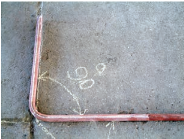
شکل ۳-۵۷- لوله‌ی خم کاری شده
