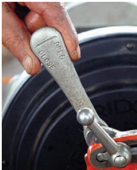
شکل ۴-۹۷- کشیدن ضامن تنظیم به عقب
