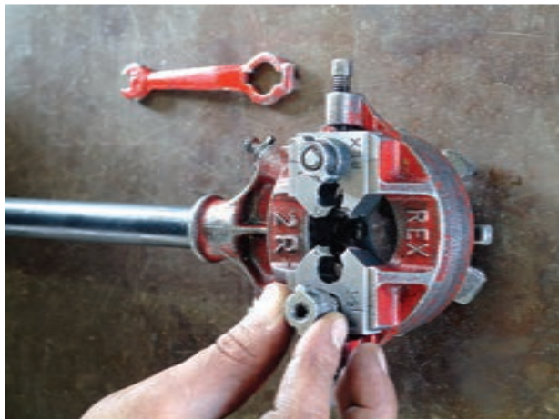
شکل ۴-۲۷- بستن مهره‌ها بر روی پارچه‌های حدیده
