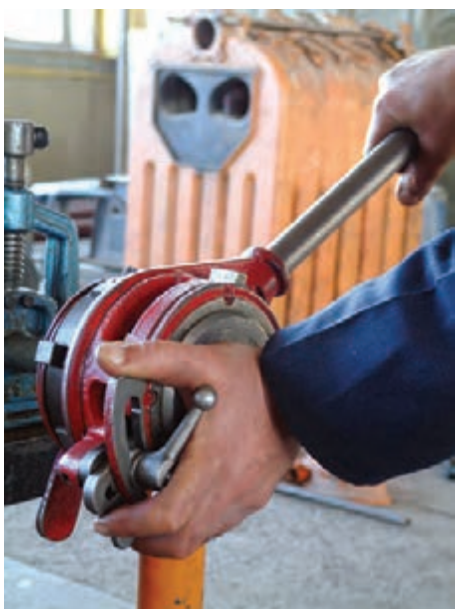
شکل ۱۲۲-۴- عمل درگیر کردن پارچه‌ها با سر لوله
