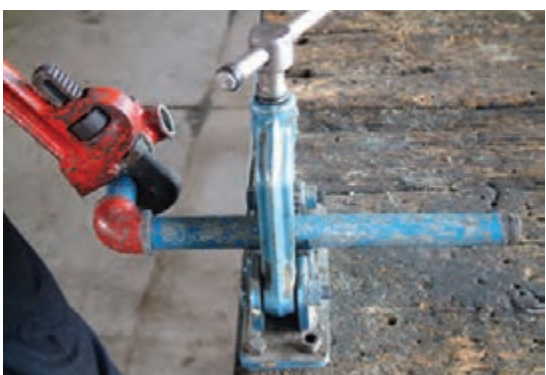
شكل ۵-۱۵۴- بستن لوله‌ی ضلع دوم مدار
