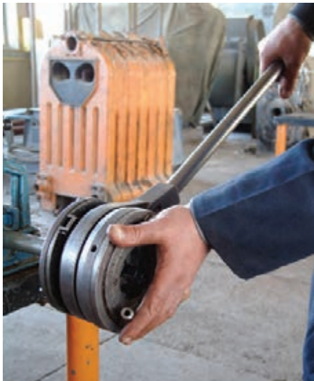
شکل ۴-۶۶- درگیر کردن حدیده با سر لوله
