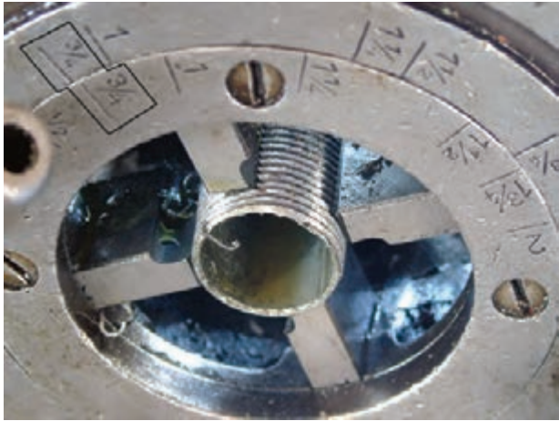
شکل ۴-۶۹- حد صحیح حدیده کردن لولهی ۳/۴"
