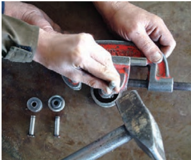
شکل ۱-۱۹- خارج کردن پین‌ها به وسیله‌ی سنبه‌نشان و چکش فلزی
