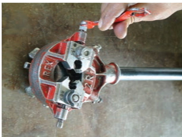
شکل ۲۰-۴- اجزای حدیده‌ی دستی دو پارچه
