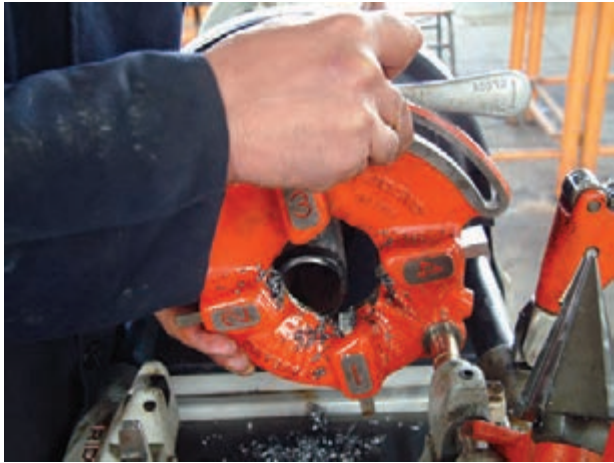
شکل ۴-۹۰ جدا کردن تنه‌ی حديد از دستگاه
