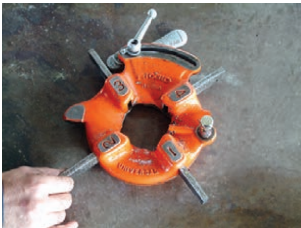
شکل ۴-۹۱ مرحله‌ی اول: ترتیب قرارگیری پارچه‌ها در شیارهای تنه‌ی حديد
