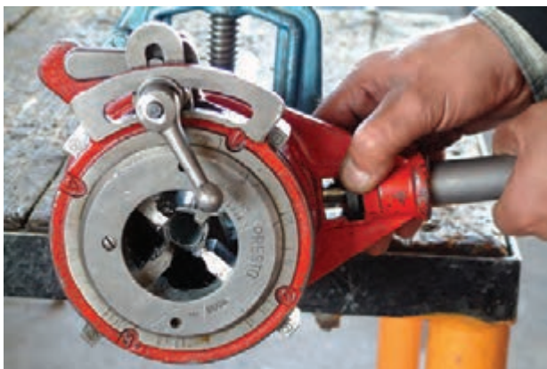
شکل ۱۲۱-۴- قرار دادن ضامن تغییر جهت دهنده‌ی حدیده در حالت حدیده‌کردن
