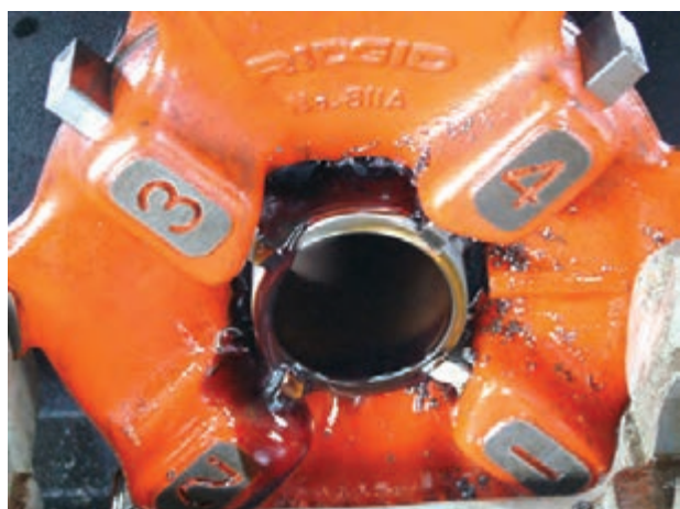
شکل ۴-۹۵- عمل حدیده‌کاری به وسیله حدیده‌ی ماشینی
