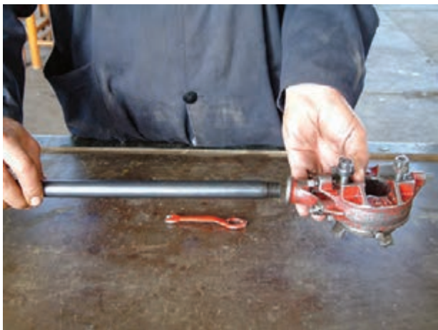
شکل ۴-۲۵- اتصال دسته‌ی حدیده به بدنه‌ی حدیده
