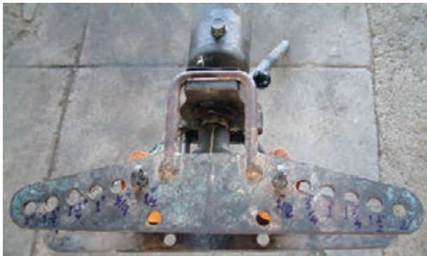
شکل ۳-۱۷- محل های مشخص شده بر روی صفحه ی راهنما
