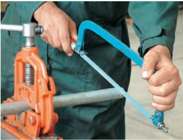
شکل ۵۰-۱- عدم رعایت فاصله‌ی مناسب از لب گیره
