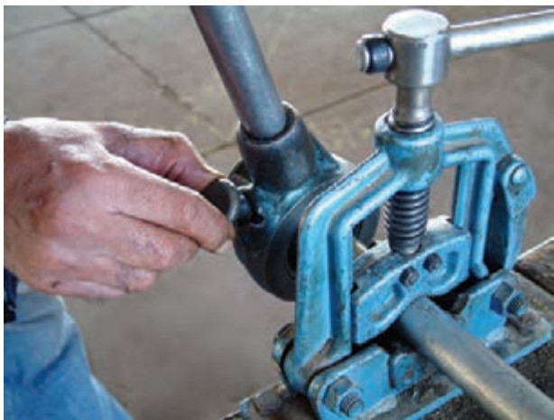
شکل ۴-۴۶- قرار دادن ضامن در جهت حدیده کردن
