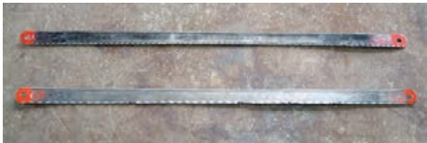
شکل ۱-۴۰ - از بین رفتن دندان‌های تیغه اژه
