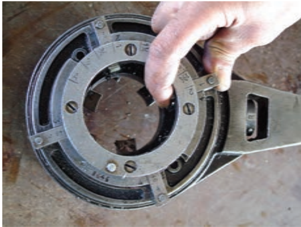
شکل ۴-۶۰- قرار دادن پارچه‌های مناسب در حدیده
