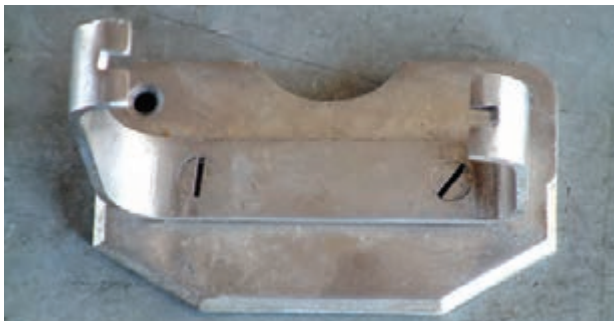
شکل ۴-۵- اتصال موقت با استفاده از پیچ
