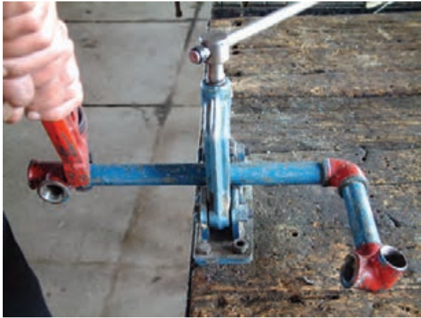
شکل ۵-۱۵۵- بستن سه‌راهی به ضلع دوم مدار
