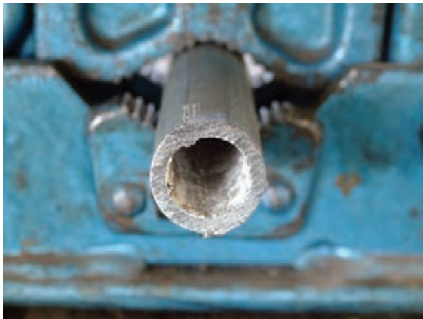
شکل ۱-۵۲- لوله‌ی بسته شده به گیردی لوله
