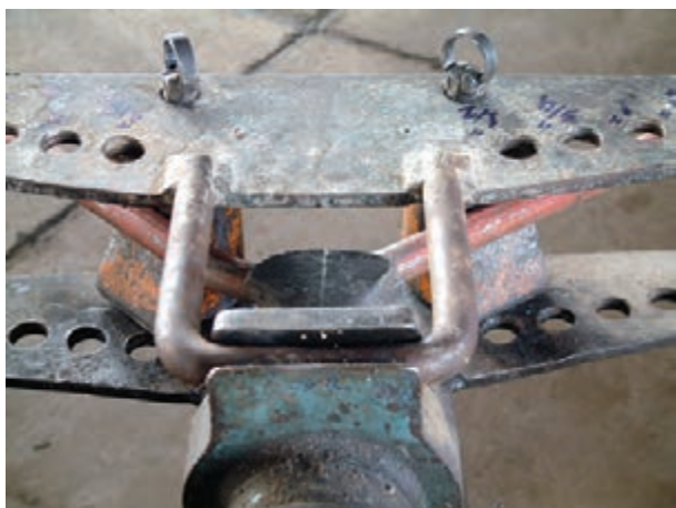
ب- باز کردن خم لوله‌ی خم شده
