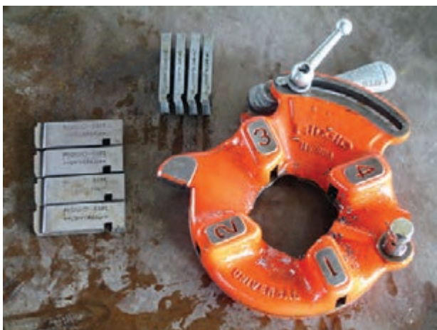
شکل ۸۹-۴- مشخصات حک شده بر روی پارچه‌های حدیده
