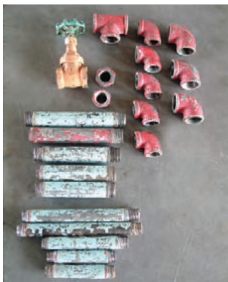
شکل ۵-۱۳۱- حدیده کردن همه‌ی لوله‌ها و آماده کردن شیرفلکه و فیتینگ‌ها
