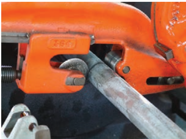
شکل ۴-۱۳۷- بریدن لوله به وسیله‌ی لوله بُر
