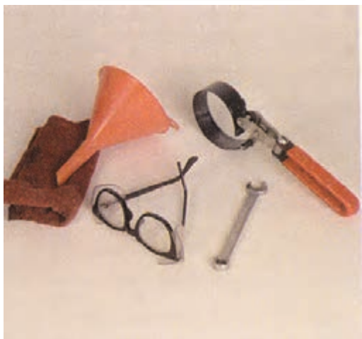
شکل (۲-۴۳) ابزار عمومی و بازبست فیلتر
