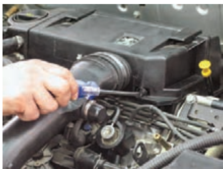
شکل (۲-۶۵) نصب در پوش محافظه فیلتر هوا
