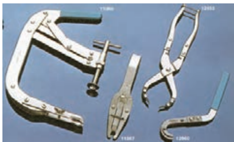
شکل (۱-۷) فنر جمع کن سوپاپ
