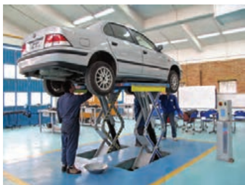
شکل (۲-۷۲) خودرو روی بالابر در ارتفاع مناسب
