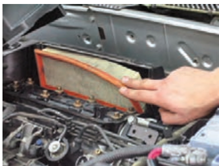
شکل (۲-۶۴) پیاده کردن فیلتر هوا
