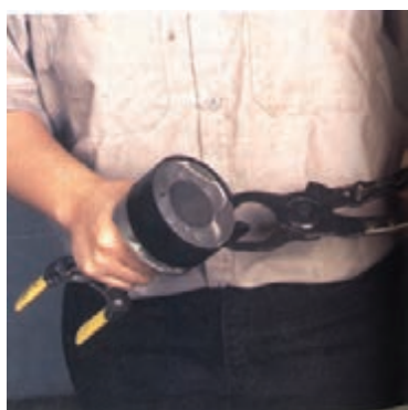
شکل (۱-۵۱) استفاده از رینگ جمع کن
