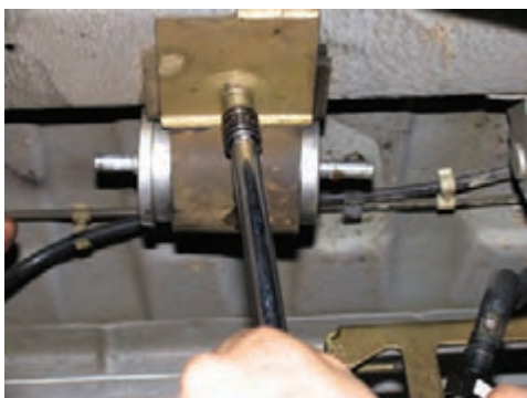
شکل (۲-۶۸) نصب فیلتر جدید
