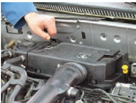
شکل (۲-۶۳) بازکردن در هواکش
