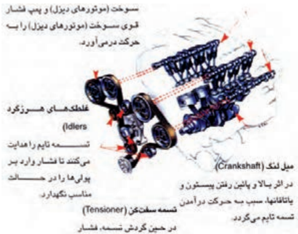
شکل (۱۳-۲ الف) تسمه تایمینگ موتور
