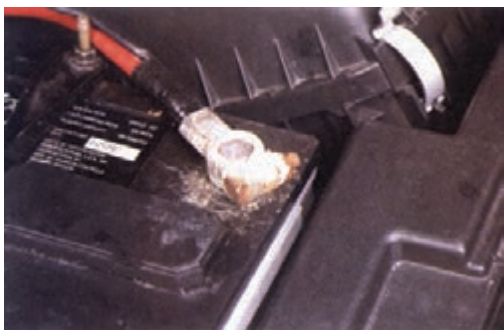
شکل (۲-۸۱) سولفاته شدن بست باتری
