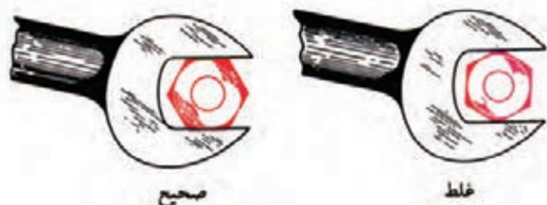
شکل (۱-۵۰) استفاده ی صحیح و غلط از آچار
