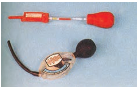
شکل (۲-۷۸) هیدرومتر اسیدسنج
