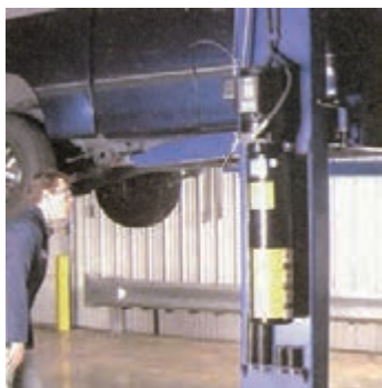
شکل (۴۷- ۲) اطمینان از استقرار ایمن خودرو
