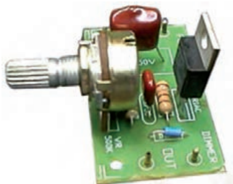
شکل ۵۵-۳- مدار ظاهری یک دایمر روشنایی
