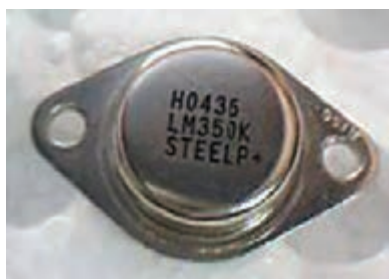
شکل ۱-۵۵- آی سی رگولاتور قابلمه ای
