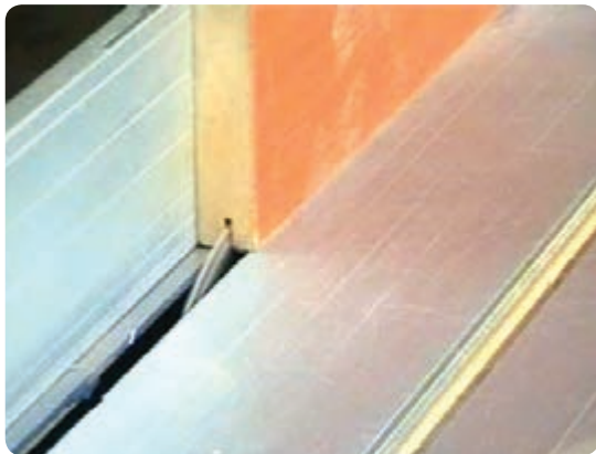
شکل ۶-۹۰ دو راهه کردن با ماشینی ارهٔ مجموعه‌ای
