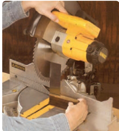
شکل ۷-۲ تنظیم عمود بودن تیغه پشت به صفحه
