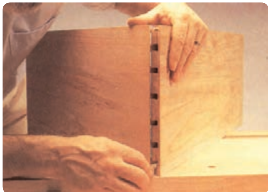
شکل ۶-۱۴۰ مونتاژ آزمایشی قبل از چسب زدن قطعات
