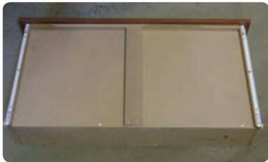
شکل ۶-۱۱۳ نصب قید کمرکش در کنسولهای بزرگ
