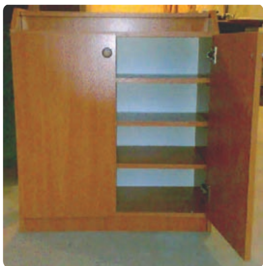
شکل ۱۳۲-۶ نصب پراق آلات در کابینت جاکفشی
