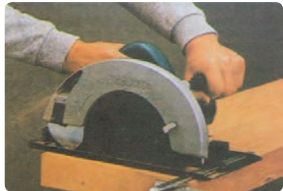
شکل ۳۶-۲ برش به وسیله گونیای دستگاه
