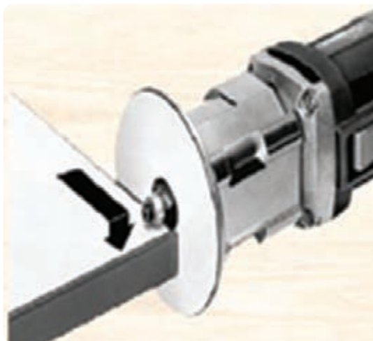
شکل ۱۵۵-۲ پرداخت لبه‌های اضافی روکش مصنوعی
