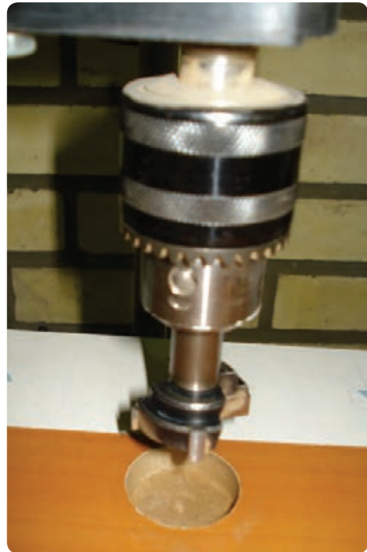
شکل ۶-۷۱ مته کابینت جهت سوراخ کردن جای لولا
