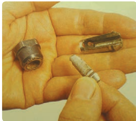
شکل ۴۱-۲ بوش تیغه اور فرز همراه با مهره سفت‌کننده تیغه روی شفت دستگاه
