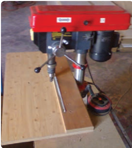
شکل ۶-۷۰- دریل ستونی همراه با شابلون جهت سوراخ‌کاری
