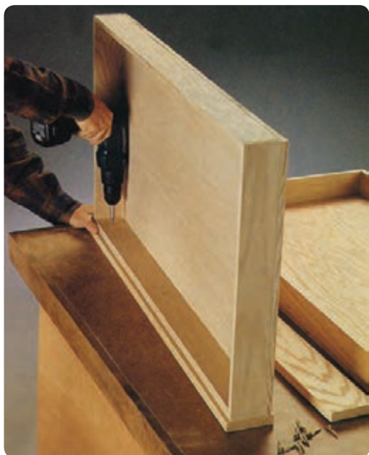
شکل ۴۰- کاربرد تخته سه‌لایه در کف جعبه
