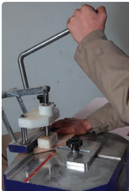
شکل ۲-۱۱۲ برش با زاویه ۴۵ درجه
