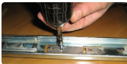
شکل ۷-۳۴ پیچ کردن ریل به بدنه فایل
