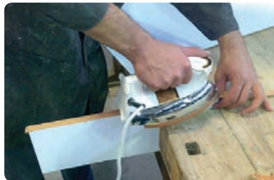
شکل ۶-۸۱ لبه چسبانی روکش مصنوعی با اتو
