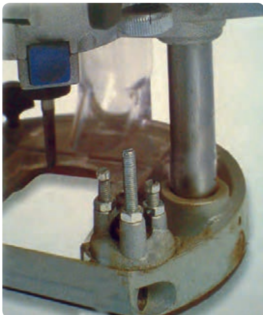
شکل ۴۴-۲ پیچ‌های تنظیم ارتفاع اور فرز دستی برقی
