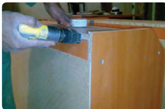
شکل ۱۳۱-۶ نصب لولای محفظه جاواکسی
