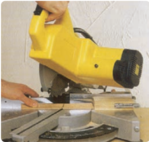
شکل ۲-۱۲- برش قائم با اره گرد فارسی بر
