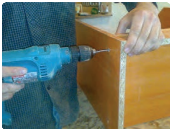
شکل ۱۲۹-۶ مونتاژ با دریل مجهز به سر پیچ گوشتی
