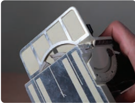
شکل ۲-۹۴ اتصال زن بیسکویتی بدون گونیا
