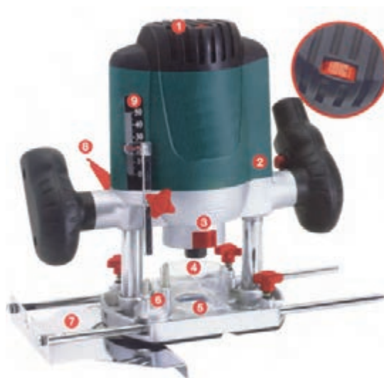
شکل ۲-۳۹ قسمت‌های مختلف ماشین اور فرز دستی برقی
