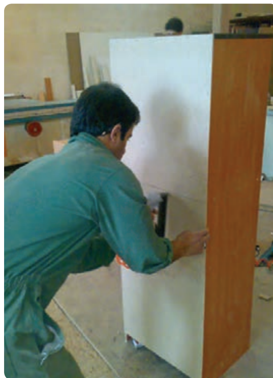
شکل ۱۲۱-۶ نصب پشت بند کابینت
