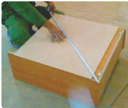
شکل ۱۳۰-۶ کنترل دویدگی کابینت
