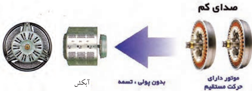
شکل ۱-۱۴۴-الباسشویی اتوماتیک با انتقال نیروی مستقیم
