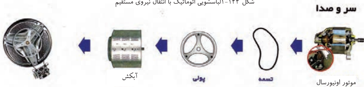
شکل ۱-۱۴۵-الباسشویی اتوماتیک با انتقال نیروی غیرمستقیم
