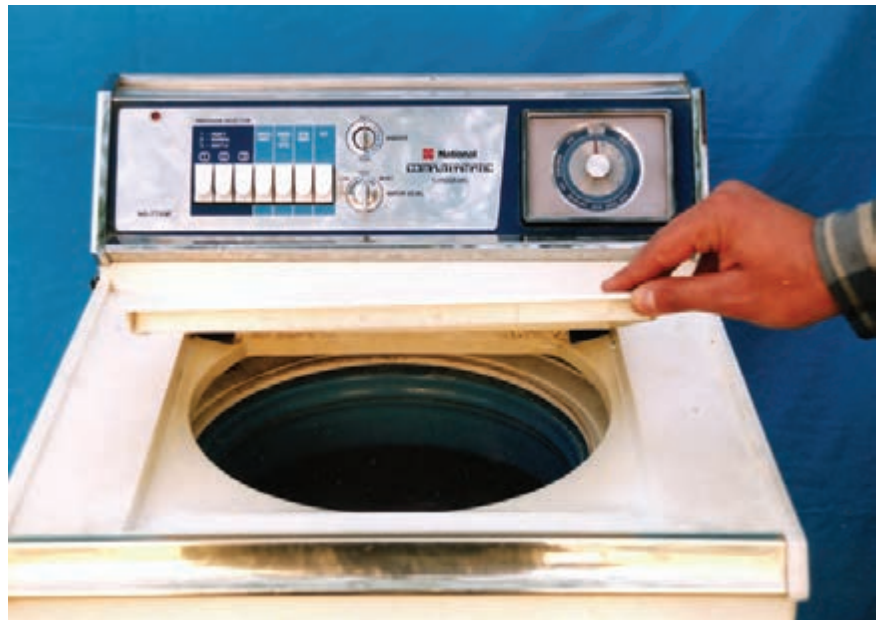
شکل ۱-۱۳۵ لباسشویی اتوماتیک در از بالا دارای تسمه و پولی و شفت و پروانه کوتاه
