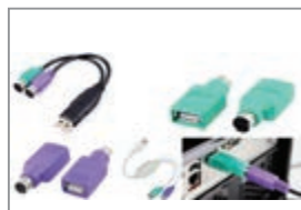
شکل ۱-۵۶- مبدل PS/2 به USB و برعکس
