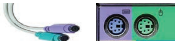
شکل ۴۸-۱ پورت PS/2 شکل ۴۹-۱ کابل مربوط به پورت PS/2
