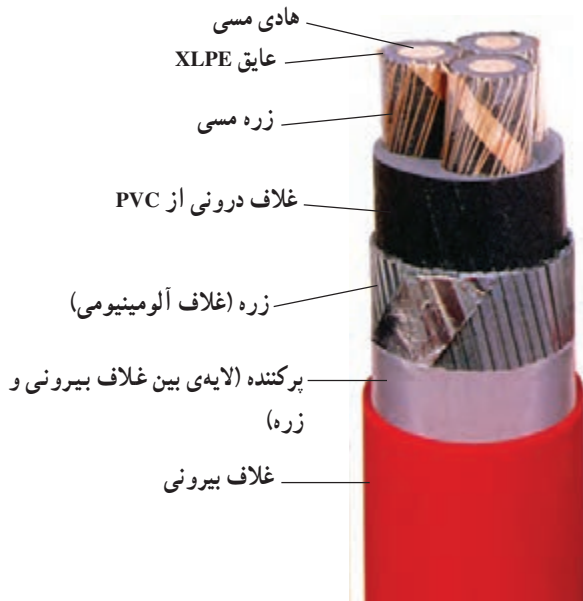
شکل ۵-۷- کابل با غلاف آلومینیومی
