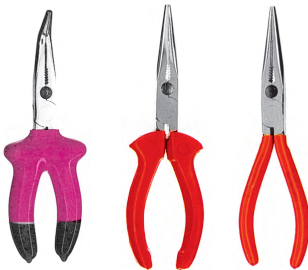
الف - دم باریک دسته ب - دم باریک دسته عایق ج - دم باریک دسته عایق فشار قوی با نوک کج ۴۵°
