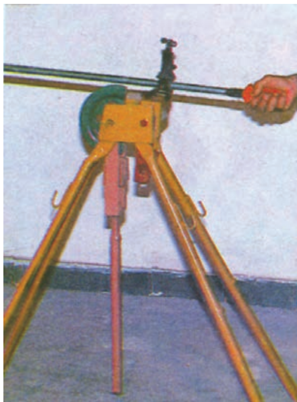
ج - پلیسه‌برداری داخل لوله توسط برقو
