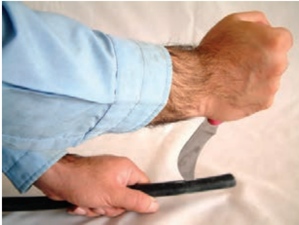
شکل ۳۳-۵- طریقه‌ی صحیح روکش برداری کابل
