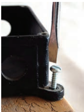
شکل ۲-۱۶- ابزار سالم و مناسب برای باز کردن یک پیچ
