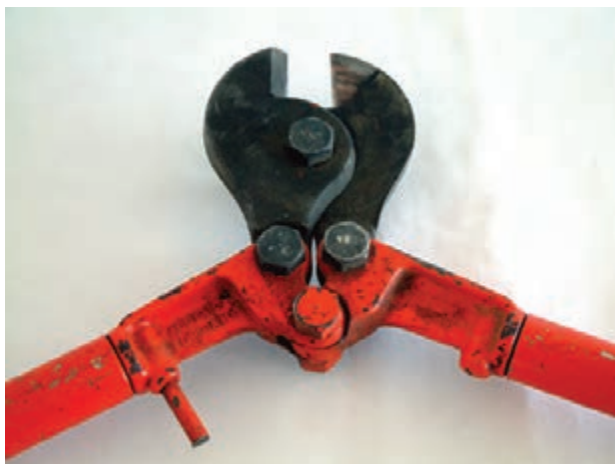
شکل ۵-۷۳- قیچی کابل بری
