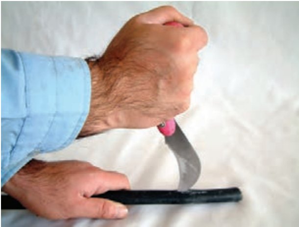
الف - نحوه‌ی غلط لخت کردن کابل
