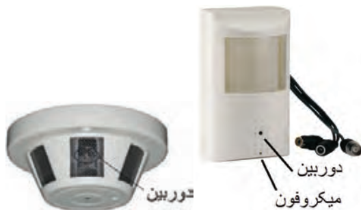
شکل ۳-۴ دوربین‌های مخفی در داخل آشکارسازها
