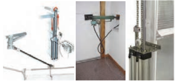
شکل ۲-۴ سیستم‌های در اتوماتیک پنوماتیک
