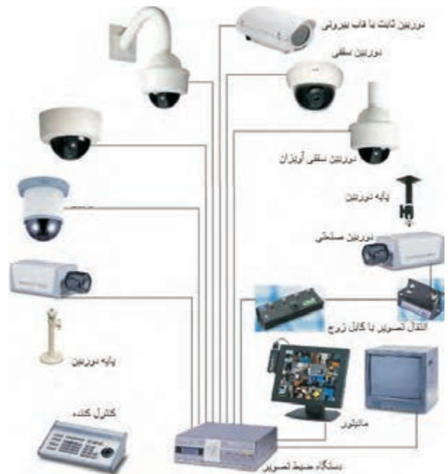
شکل ۳-۱ نمونه سیستمی که توسط سیم کواکسیال (کابل هم محور) تصویر را منتقل می‌کند
