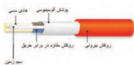
شکل ۱-۲۴ قسمت‌های مختلف یک کابل اعلام حریق
