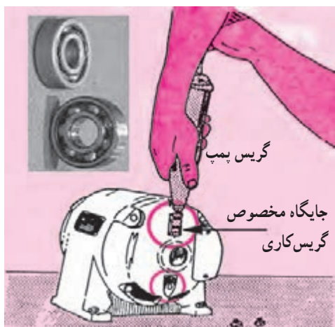
شکل ۱-۳۳ - گریس کاری بلبرینگ‌ها
