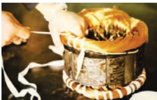
شکل ۴-۱۸- نواربندی سیم‌های استاتور
