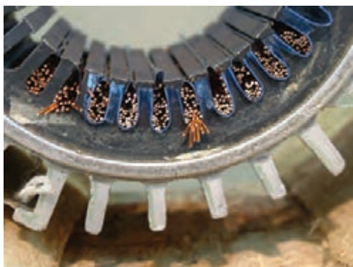
شکل ۲-۲۱ - برش سیم ها در یک طرف استاتور
