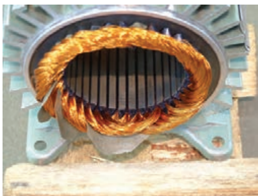
شکل ۲-۳۱- عایق‌کاری پیشانی کلاف‌ها
