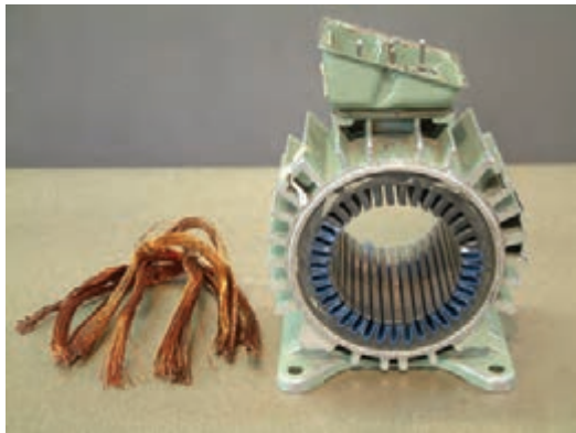
شکل ۲۴-۲- سیم‌های بیرون آمده از استاتور
