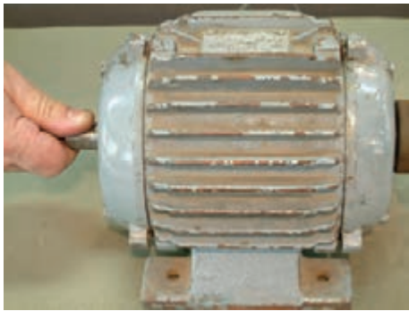
شکل ۴۵-۱- بررسی لقی بوش‌ها
