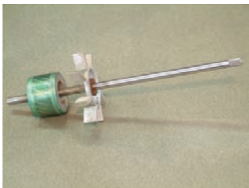
شکل ۱-۲۸- پروانه‌ی نصب شده روی محور روتور
