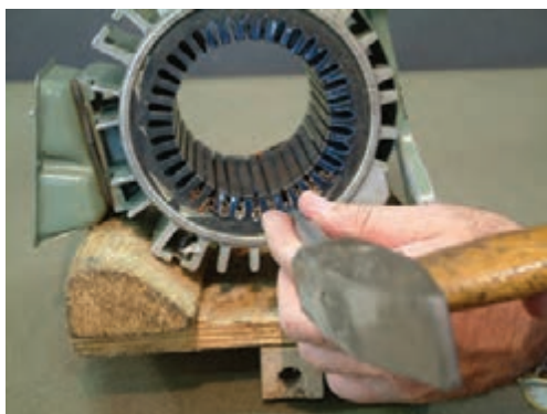
شکل ۲-۲۳ - هدایت سیم ها به طرف دوم استاتور
