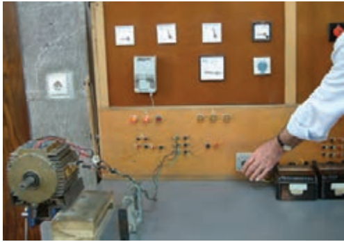
شکل ۹-۶- اتصال موتور به تابلوی برق
