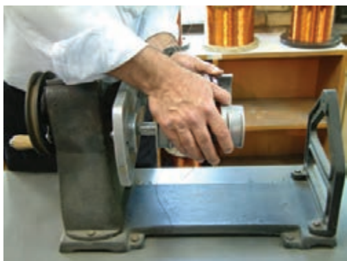
شکل ۱۸-۳ باز کردن قالب‌ها
