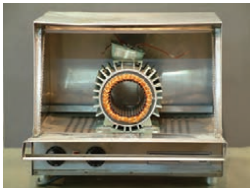
شکل ۲۰-۴- گرم کردن استاتور
