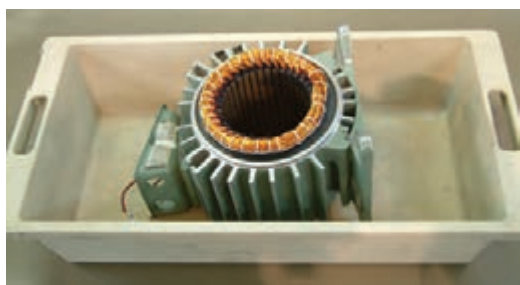
شکل ۲۱-۴- قرار دادن استاتور در درون وان شارلاک
