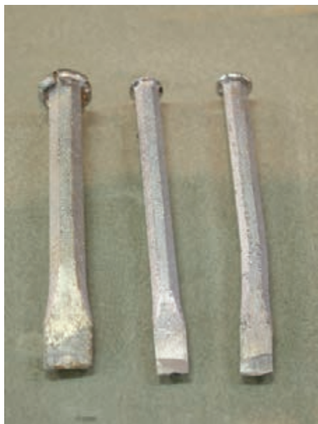
شکل ۲-۱۹- چند نمونه قلم برای بریدن سیم‌ها
