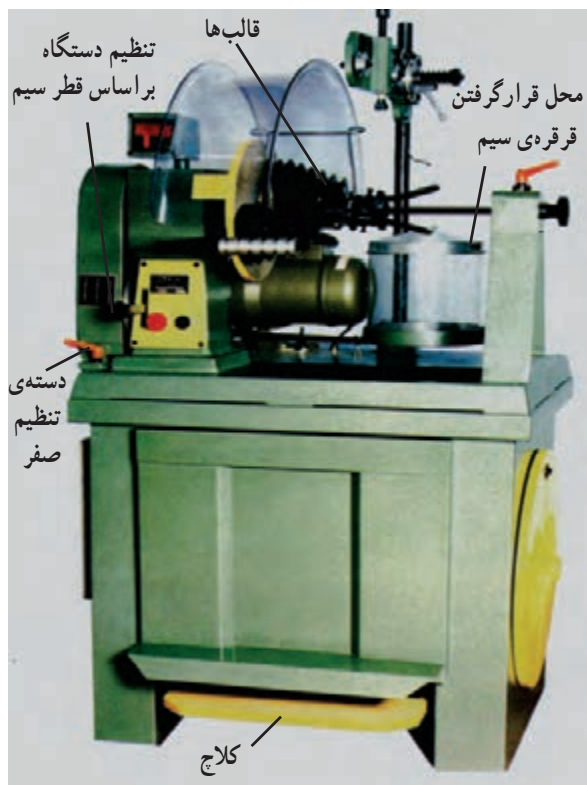
شکل ۱۳-۳- ماشین کلاف پیچ
