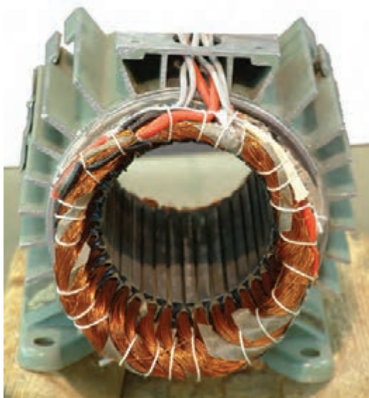
شکل ۴-۱۷- نمایش استاتور نخ‌بندی شده از دو سمت
