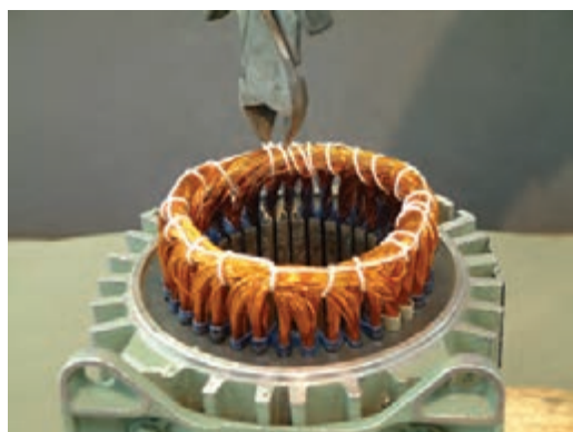
شکل ۲-۱۳ - چیدن نخ‌های کلاف‌بندی با سیم‌چین
