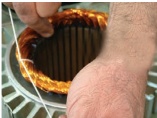
شکل ۴-۱۴- گره زدن یک سر نخ
