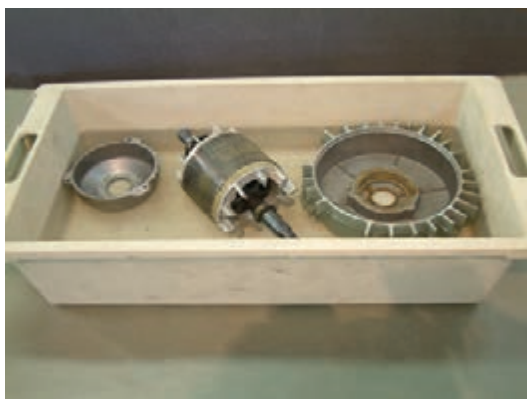
شکل ۱-۳۲ - شست‌وشوی قطعات با آب گرم
