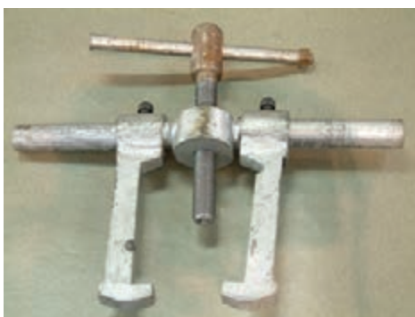
شکل ۴۸-۱- ابزار درآوردن بوش و یاتاقان‌های استوانه‌ای
