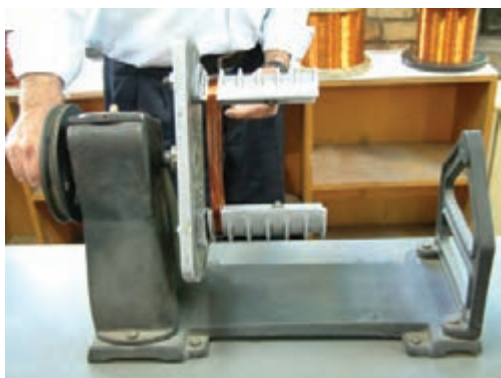
شکل ۱۷-۳ پیچیدن سیم‌ها روی قالب‌ها
