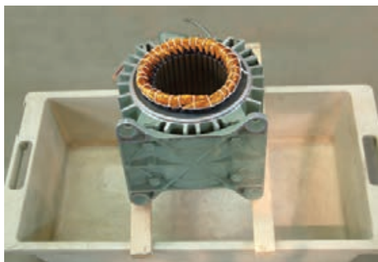
شکل ۲۴-۴ – قرار دادن استاتور روی وان
