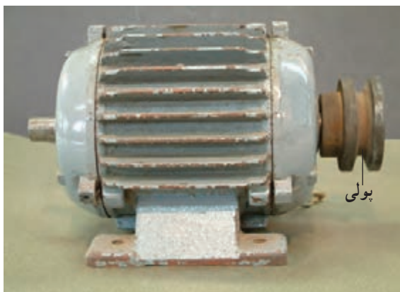
شکل ۱-۱ - موتور سه فاز کامل
