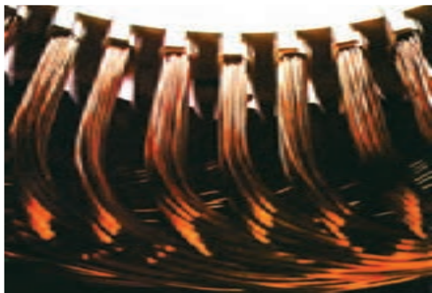
شکل ۲-۳۰- عایق‌گذاری بین طبقات
