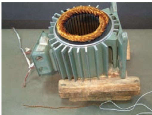
شکل ۴-۱۳- آماده کردن نخ و سوزن
