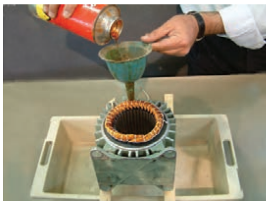
شکل ۲۵-۴ – ریختن شارلاک روی سیم ها
