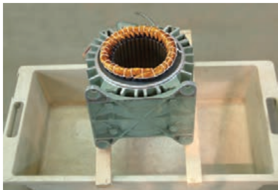
شکل ۴-۲۲- خارج کردن اضافات شارلاک از استاتور
