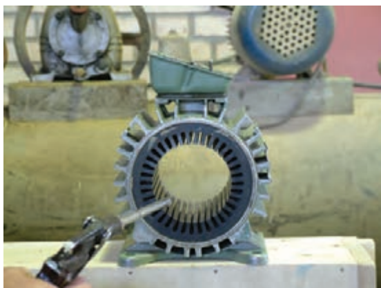
شکل ۱-۳۱ - بادگیری قطعات جدا شده
