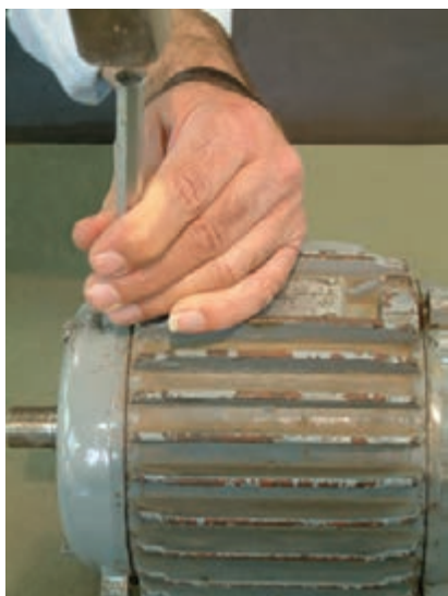
شکل ۱-۲۳- علامت گذاری روی پوسته و درپوش‌ها
