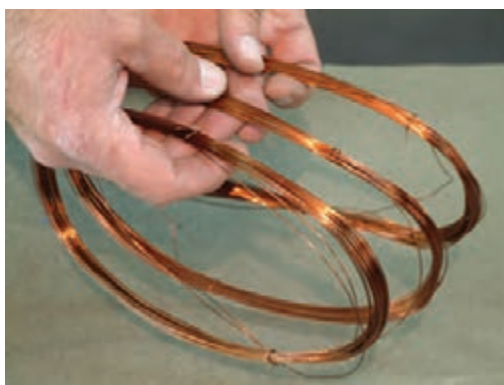
شکل ۱۹-۳ درآوردن کلاف از قالب
