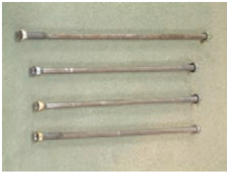
شکل ۱-۴۲ پیچ‌های بلند دو طرف رزوه شده
