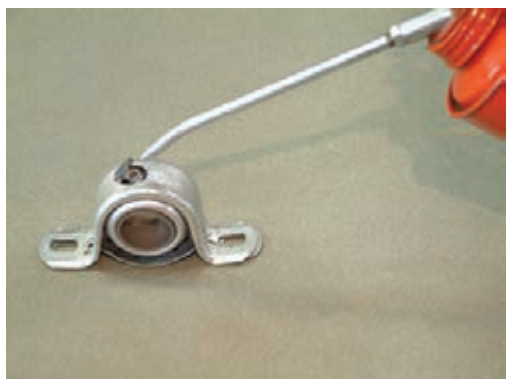
شکل ۱-۳۴- روغن کاری یاتاقان ها
