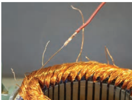
شکل ۴-۱۱- اتصال سیم‌های افشان به سیم‌های لاک‌ی
