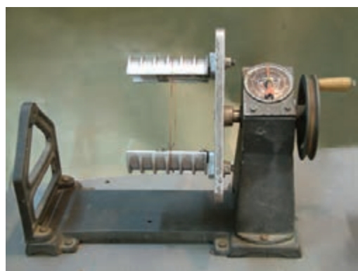
شکل ۳-۵- تنظیم قالب‌ها بر اساس اندازه‌ی کلاف
