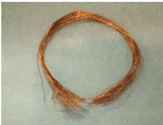
شکل ۱۶-۳- الف - شمارش تعداد دور هر بوبین
