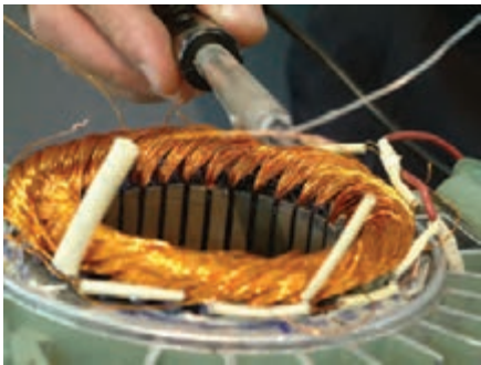
شکل ۴-۷- لحیم کاری محل اتصال سیم ها
