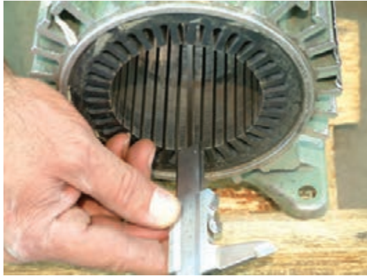
شکل ۲۶-۲- اندازه گیری محیط داخلی و طول شیار
