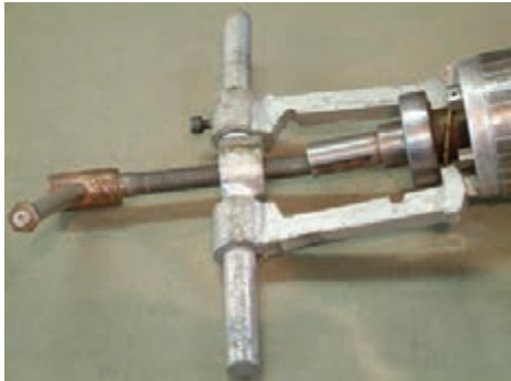
شکل ۴۶-۱- استقرار بلبرینگ کش‌روی محور روتور
