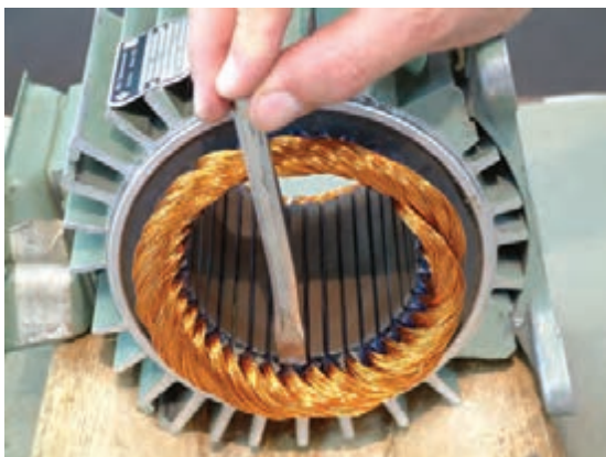
الف- قرار دادن قلم روی سیم‌ها
