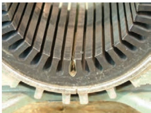
شکل ۲-۳۳- اندازه‌گیری محیط شیار
