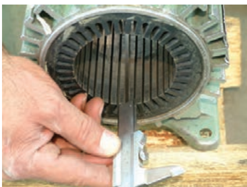
شکل ۲-۳۲- اندازه‌گیری طول شیار
