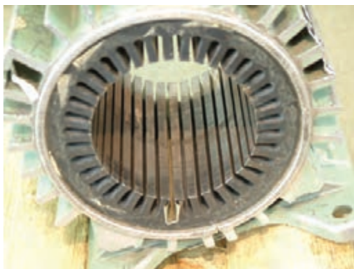
شکل ۲-۳۶- آزمایش عایق در داخل شیار
