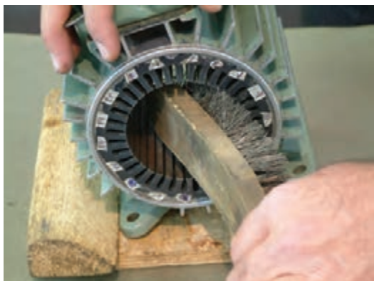
ب – تمیز کردن استاتور با برس سیمی
