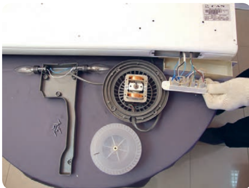
شکل ۱-۲۳ نقشه انفجاری هود آشپزخانه (دید از بالا)
