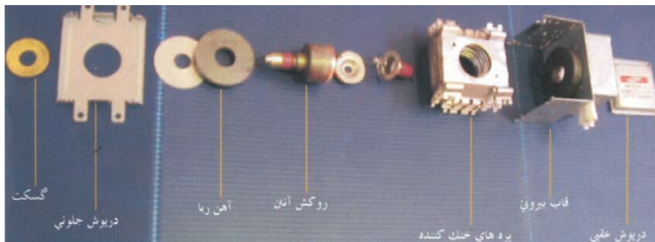
شکل ۳-۹۶ نقشه ی انفجاری قطعات یک مگنترون
