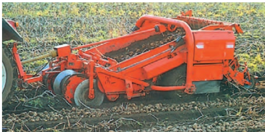
شکل ۱-۲۸- سیب‌زمینی‌کن در حال کار
