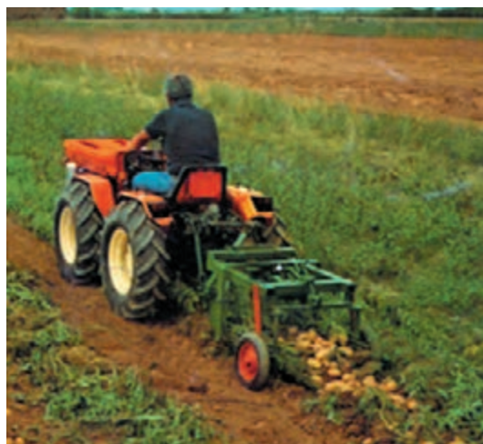
شکل ۱-۲۹- نوع دیگر غده‌کن در حال کار
