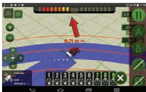
شکل ۵۸- سم‌پاشی با آهنگ متغیر
