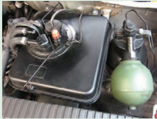
شکل ۳۶- آکومولاتور سیستم تعلیق اتومبیل زانتیا
