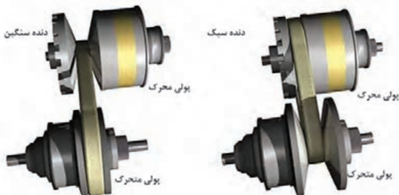
شکل ۶۲- نحوه عملکرد پولی‌های با قطر متغیر
