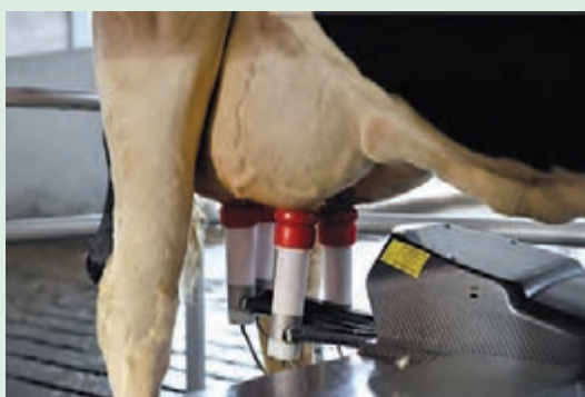
شکل ۵۵- اتصال مکنده ربات و آغاز فرایند شیردوشی
