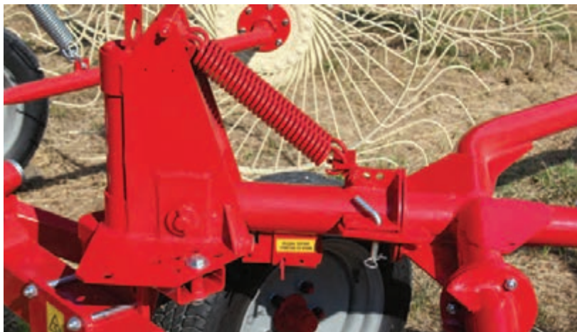
شکل ۱۵- مکانیزم شناوری شانه خورشیدی
