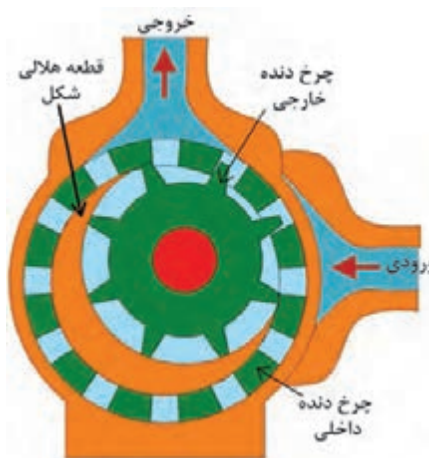
شکل ۱۵- پمپ دنده داخلی
