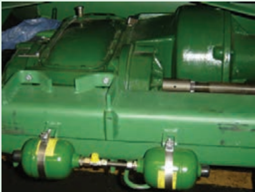
شکل ۳۷- آکومولاتور سیستم تعلیق هد کمباین جاندر ۱۰۵۵
