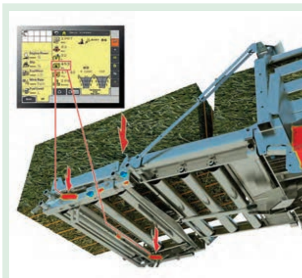
شکل ۴۹- کاربرد لودسل در بسته‌بند مکعبی
