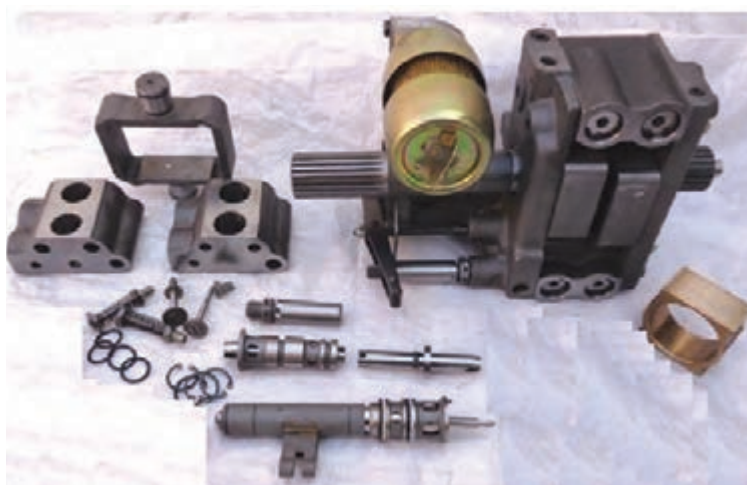
شکل ۴۸- پمپ هیدرولیک MF۲۸۵
