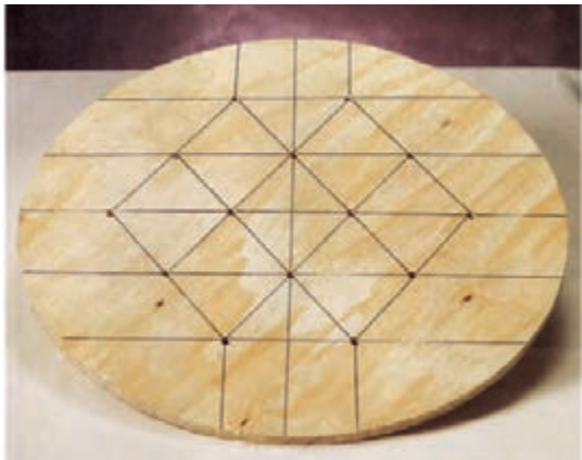
شکل ۴-۵۶- خط کشی برای لمسه کاری
