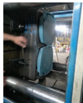
شکل ۲۶-۵- جدا کردن قالب
