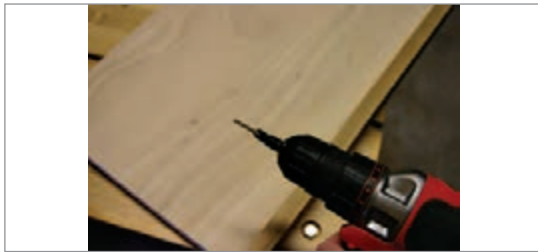
شکل ۴-۵۴- سوراخکاری با مته خزینه دار
