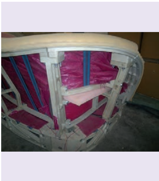
شکل ۵-۶۵- کلاف مبلمان مونتاژ شده با پیچ و مهره
