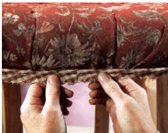
شکل ۴-۶۹- اندازه گیری و نصب سرمه
