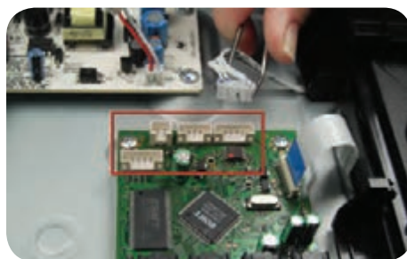
شکل ۱۹-۶ جدا کردن سوکت‌ها از برد پردازشگر
