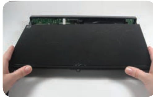
شکل ۶-۱۶ آزادسازی خارها و بیرون کشیدن قاب بالایی به صورت کشویی
