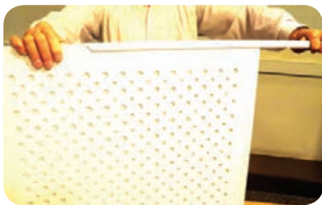
شکل ۲-۱۰- نصب قاب روی تابلو
