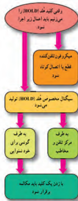
شکل ۳۲-۵- عملکرد مدار هلد
