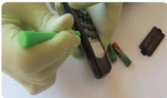
شکل ۸-۱ آزاد کردن خارهای قاب دستگاه ریموت کنترل
