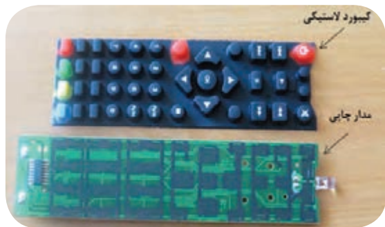
شکل ۴-۱. صفحه کلید و برد دستگاه ریموت کنترل
