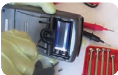
شکل ۱-۱۴- باز کردن پیچ‌ها و آزادسازی خارها
