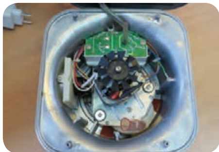
شکل ۲۴-۱- موتور، برد الکترونیکی و پروانه
