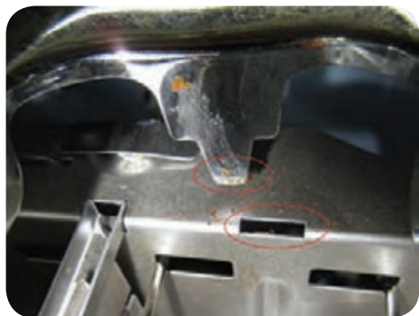
شکل ۶-۵۸ خار نر و ماده جهت اتصال
