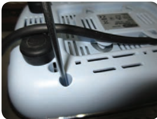
شکل ۶-۴۲ تشخیص نوع و محل پیچ‌های باز شده
