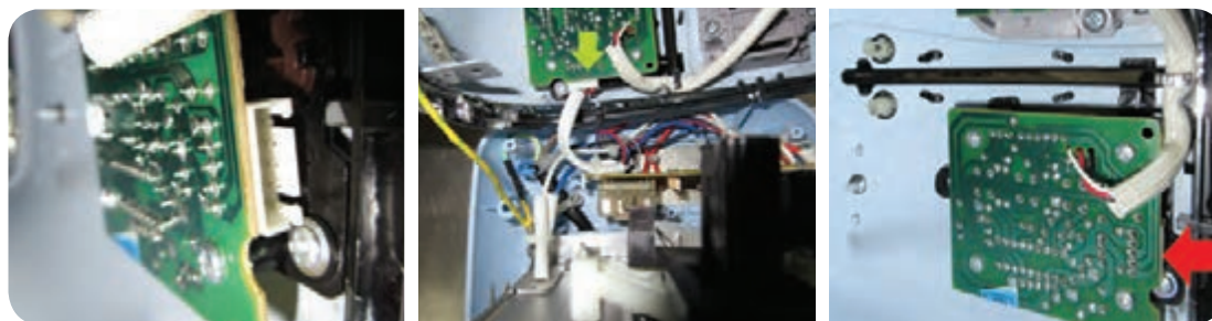
شکل ۶-۵۰ بُرد الکترونیکی شکل ۶-۵۱ محل اتصال سوکت به بُرد الکترونیکی شکل ۶-۵۲ سوکت از بُرد جدا شده است
