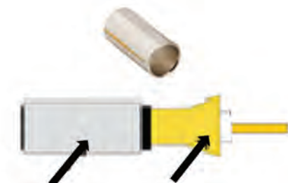
شکل ۳-۲۲- قراردادن حلقه روی کابل
