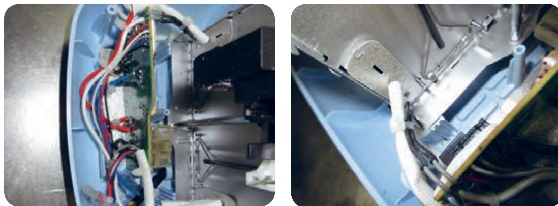
الف شکل ۶-۴۹ محل قرار گرفتن حسگر حرارتی
