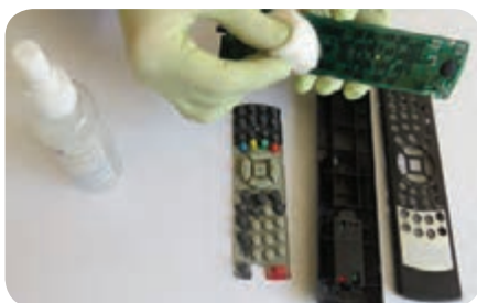
شکل ۱-۱۰- تمیز کردن کنتاکت‌ها با الکل
