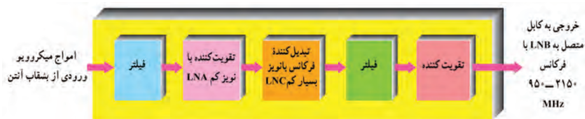
شکل ۴-۲۶ بلوک دیاگرام ساده LNB
