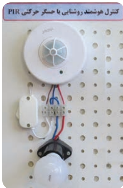
شکل ۲۹-۲ نحوه سیم‌کشی حسگر حرکتی PIR
