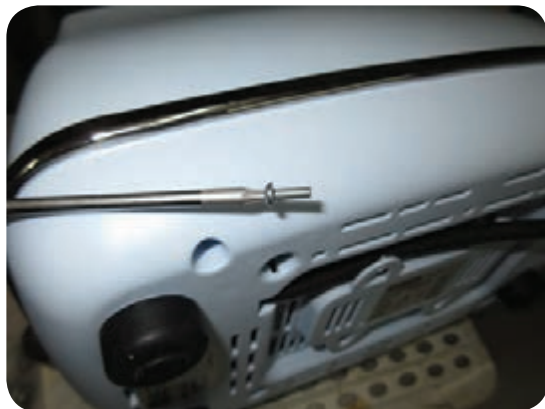
شکل ۶-۴۳ استفاده از ابزار خاص برای پیچ‌های ویژه
