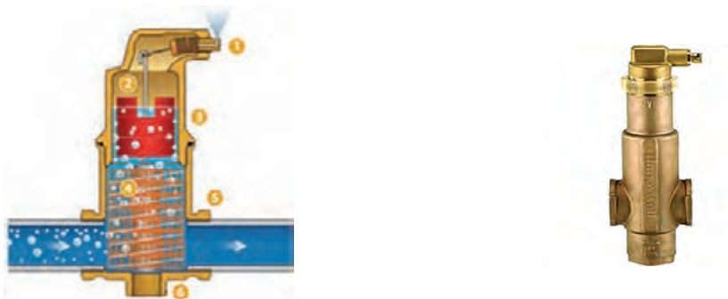
شکل ۲۰- شیر هواگیری (ایرونت)
