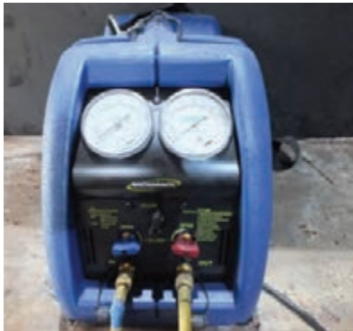
شکل ۱۵- دستگاه بازیافت گاز
