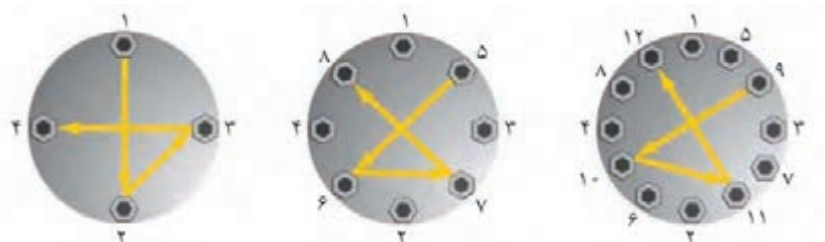
شکل ۲۳- ترتیب سفت کردن پیچ‌های فلنج
