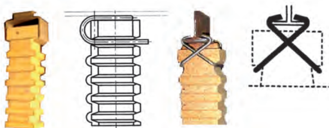
شکل ۴۲- برخی از واسطه‌های فلزی برای اتصال انکرهای سرامیکی به جداره
