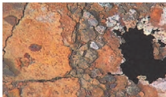
شکل ۶- نمونه‌هایی از خوردگی در دمای بالا
