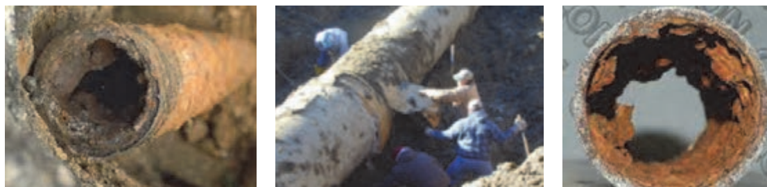
شکل ۴- نمونه‌ای از خوردگی لوله‌های دفن شده
