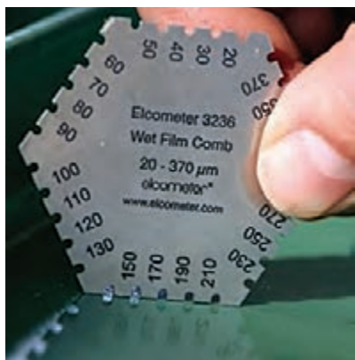
شکل ۱۹- شانۀ مخصوص اندازه‌گیری ضخامت فیلم تر رنگ
