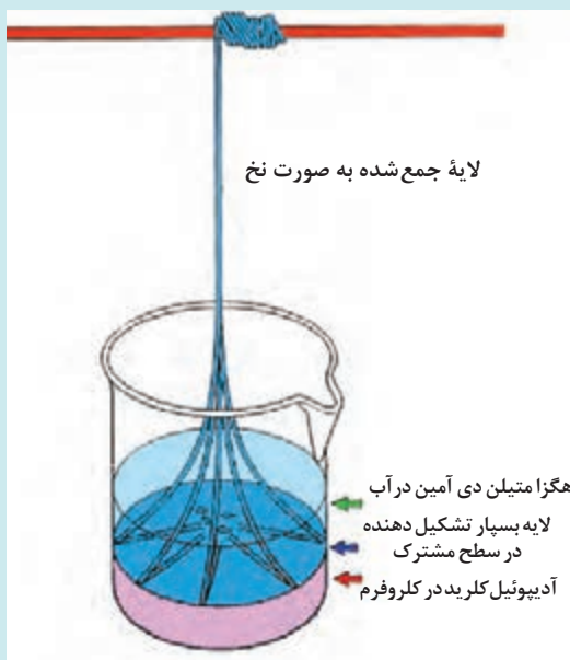
سازوکار کلی تهیه نایلون ۶-۶ از طریق بسپارش بین سطحی
