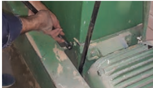
شکل ۵۹- روش باز کردن حفاظ و بررسی تسمه
