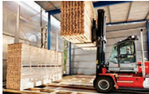
شکل ۲۳- سیستم بارگیری کوره به وسیله لیفت تراک
