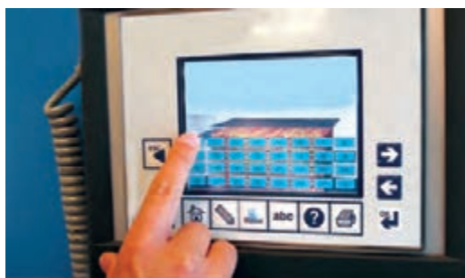
شکل ۵۱- تنظیم کنترل کننده
