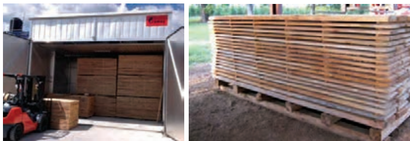
شکل ۶۶- بارگیری دسته‌بندی‌های چوب به طریق عرضی
