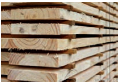
شکل ۱۳- روش چوب‌دستک‌گذاری در دسته‌های چوب
