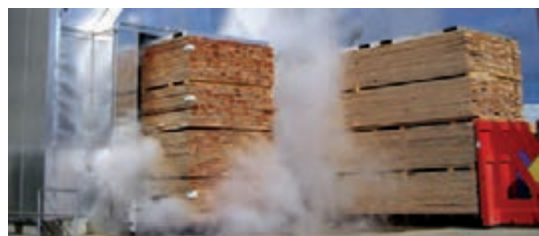
شکل ۶۴- اصول دسته‌بندی چوب روی واگن
