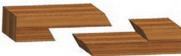
شکل ۳۸- اتصال طولی نیم و نیم
