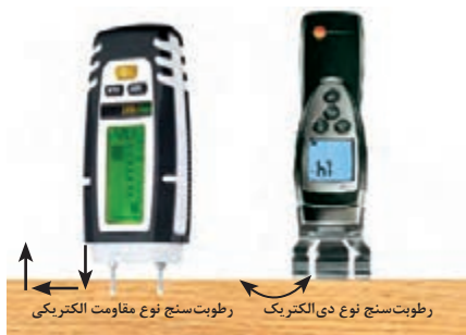
شکل ۸- روش کار رطوبت سنج های الکتریکی
