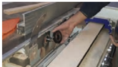
شکل ۶۲- باز کردن مهره و فلنج جلوی تیغه
