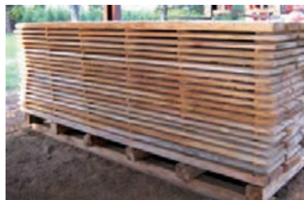
شکل ۱۳- روش چوب‌دستک‌گذاری در دسته‌های چوب
