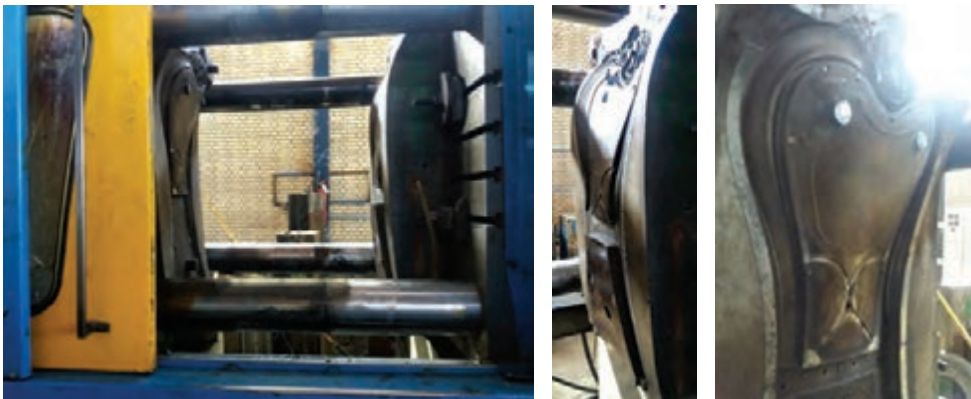
شکل ۷۴- قالب‌های مورد استفاده در ساخت مبل پلیمری
