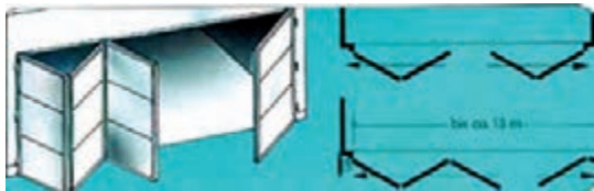
شکل ۳۱- در تاشو برای کوره‌های بزرگ‌تر تا پهنای ۱۳ متر
