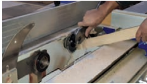
شکل ۶۴- باز کردن و بررسی تیغه خط زن
