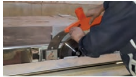
شکل ۶۷- بستن حفاظ و کاور روی تیغه ااره
