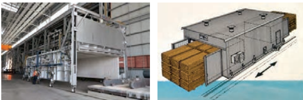
شکل ۶۷- نمونهٔ کوره‌های متحرک و سیستم عملکرد آن
