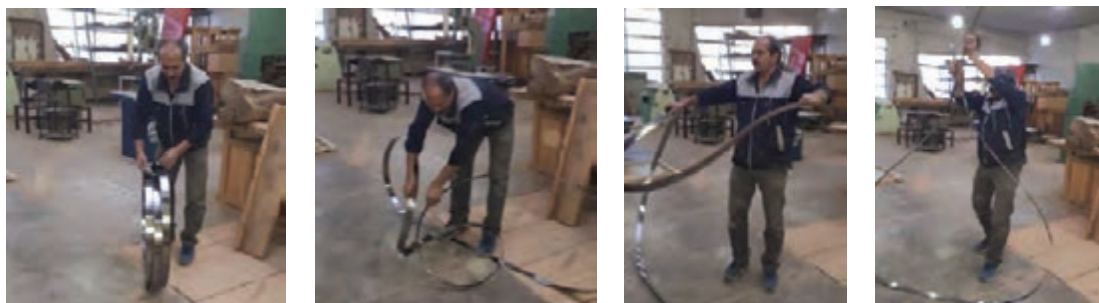
شکل ۱۹- روش جمع کردن تیغه اره نواری
