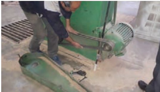
شکل ۵۹- روش باز کردن حفاظ و بررسی تسمه
