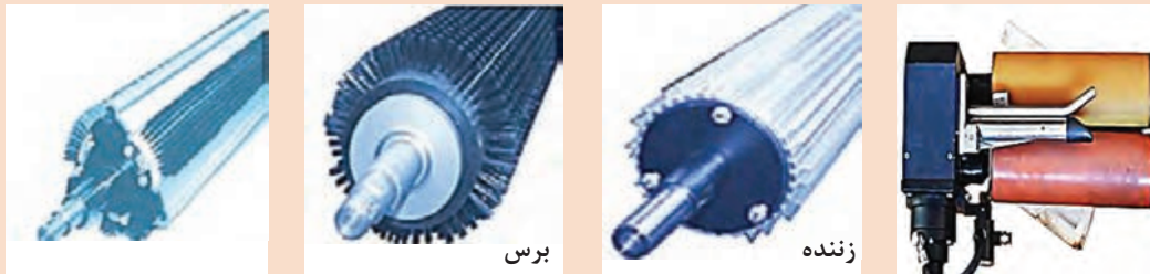
شکل ۲- یک حاشیه‌گیر پارچه و بخشی از برس مویی و زننده و برس و زننده با همدیگر در ماشین پرسوزی
