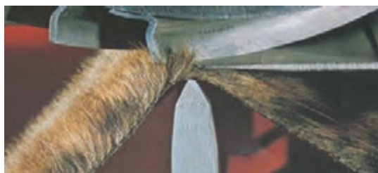
شکل ۱۰- تصویر تیغه مارپیچی و ماشین تراش پارچه
