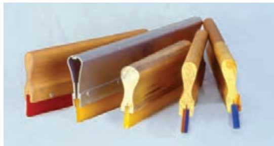
شکل ۱۵- چند نمونه راکل دستی
