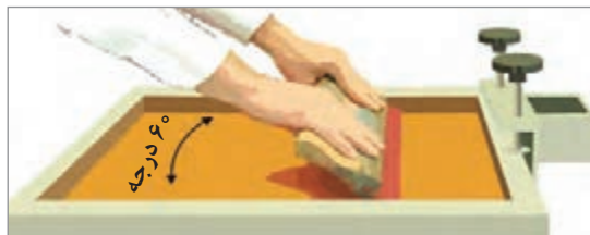
شکل ۱۶- نحوه کشیدن راکل به روش دستی
