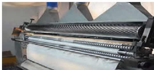
شکل ۱۰- تصویر تیغه مارپیچی و ماشین تراش پارچه
