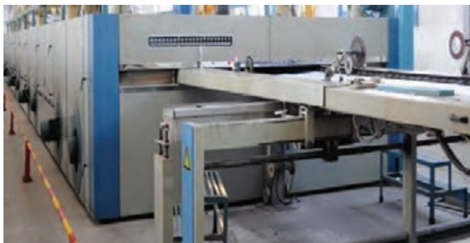
شکل ۴- نمایی از یک ماشین استنتر
