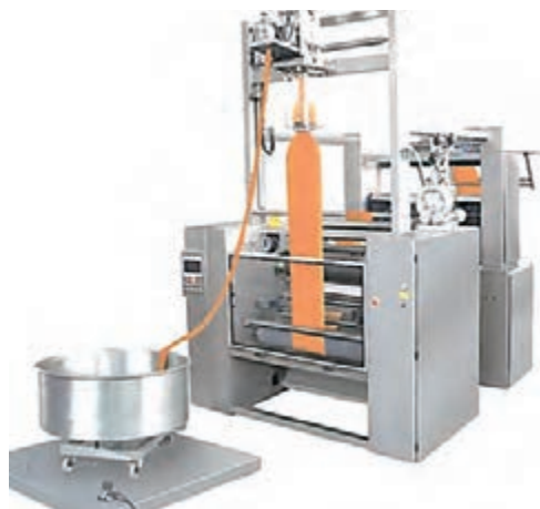
شکل ۱۴- تصویر یک آبگیر - تاب‌گیر بالنی
