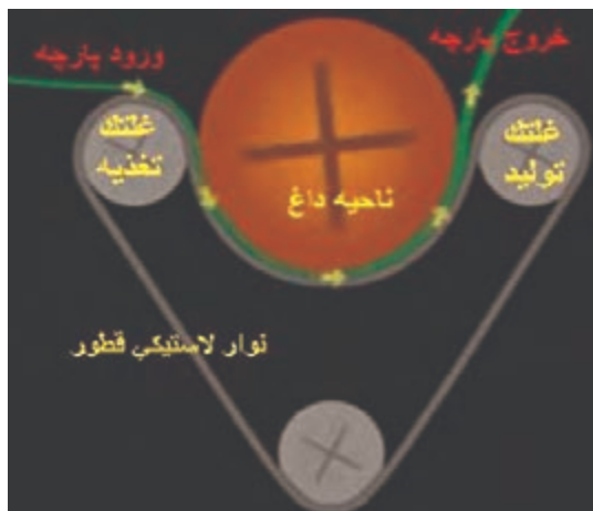
شکل ۴- قسمت تغذیه در ماشین کامپکتور
