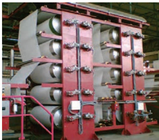
شکل ۱۵- تصویر خشک‌کن سیلندری با غلتکی عمودی
