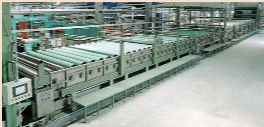
شکل ۱۲- نمایی از ماشین مرسریزاسیون غلتکی بدون زنجیر
