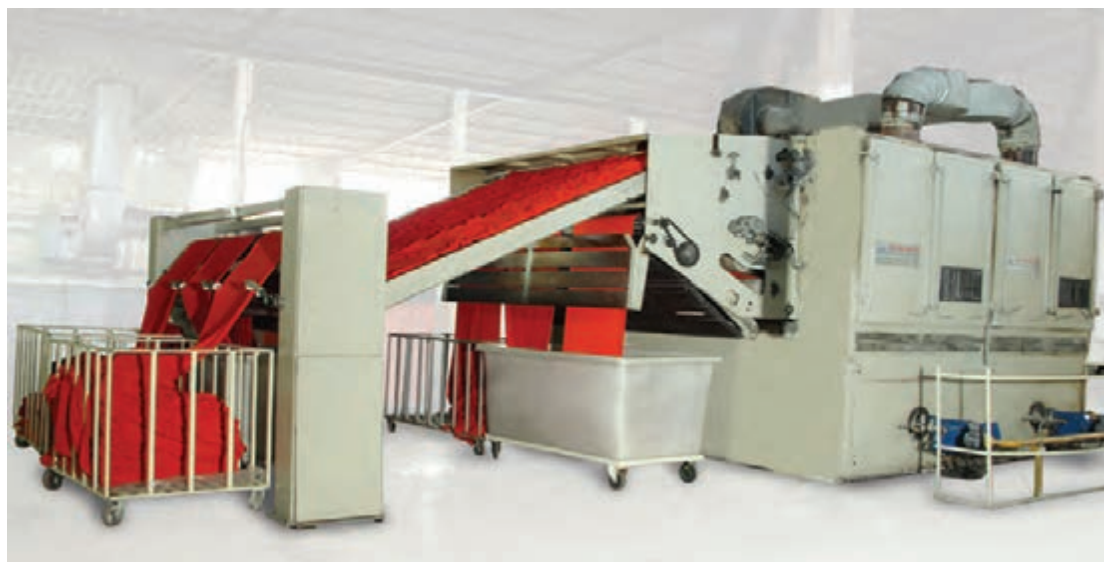
شکل ۱۹- تصویر ماشین خشک‌کن ریلکس درایر
