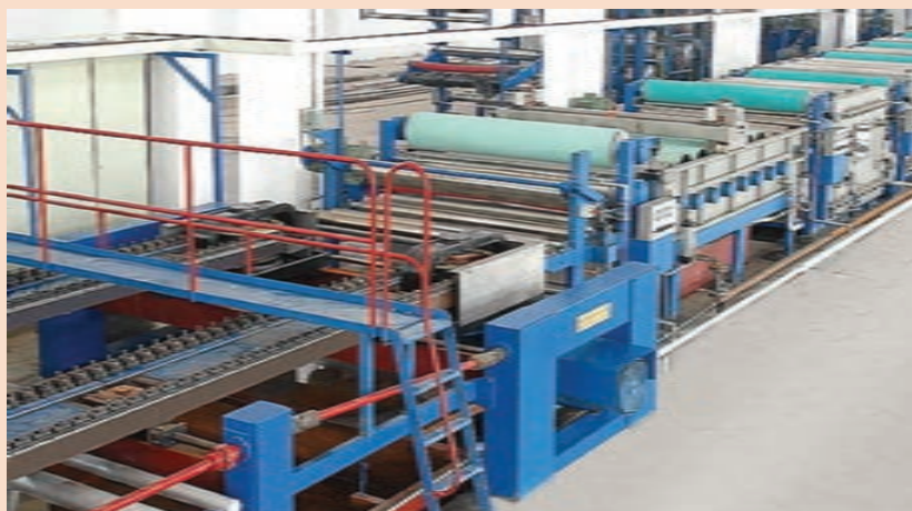
شکل ۱۱- نمایی از ماشین مرسریزاسیون زنجیری
