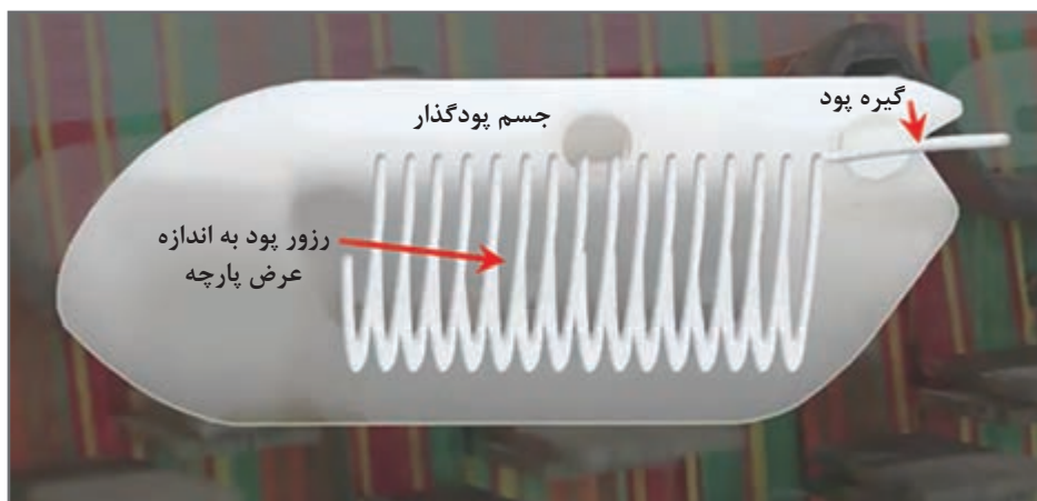
شکل ۳۰- جسم پودگذار و محل ذخیره پود.
