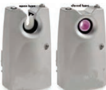
شکل ۳۱- مکانیزم کنترل نخ پود ویبرو الکتریک
