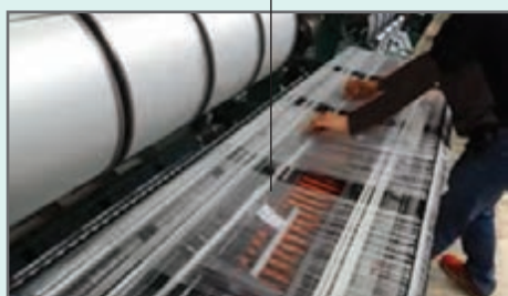
شکل ۲۰ - شاسی و ابزار دستگاه گره زن نخ و شانه صاف‌کننده
