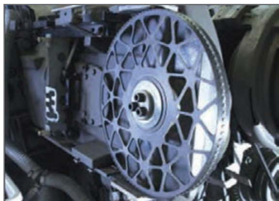
شکل ۱۹- غلتک دوران کننده و محرک راپیر
