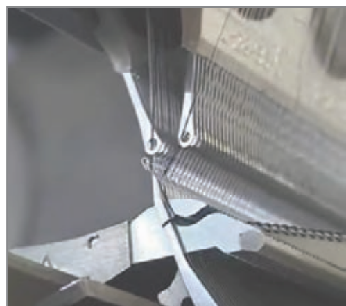
شکل ۴۲- گرفتن نخ‌ها توسط سوزن تغذیه نخ به سوزن
