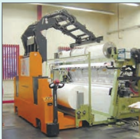
شکل ۱۹ - نحوه انتقال نورد حاوی قرقه‌ها روی ماشین
