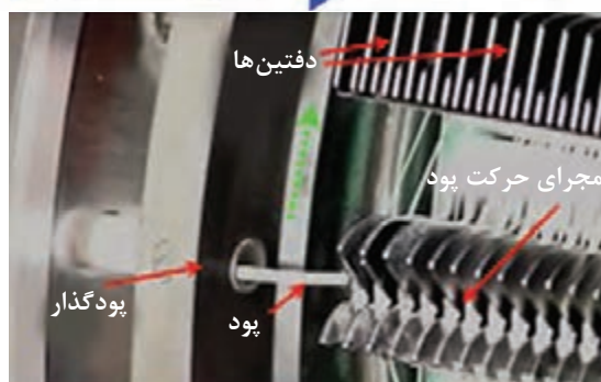
شکل ۳۴- بخش پودگذاری موازی ماشین بافندگی چند فازي ایرجت
