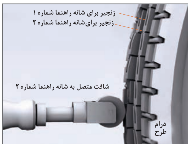
شکل ۴۷- درام طرح و نحوه ایجاد حرکت در شانه
