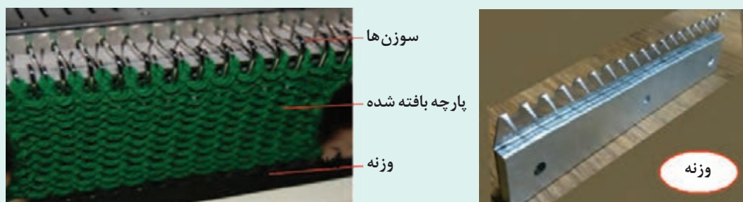
شکل ۹- روش نصب وزنه به پارچه
