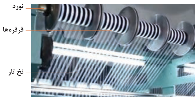
شکل ۲۷ - نورد، قرقره و مسیر نخ‌های تار از قرقره‌ها تا شانه ثابت
