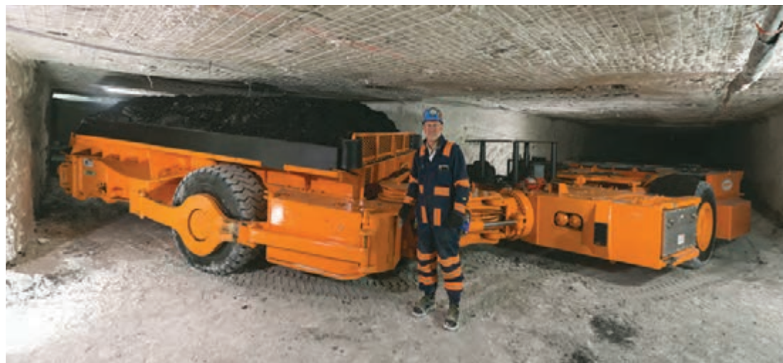
دستگاه شاتل جهت باربری مواد معدنی در معادن زیرزمینی
