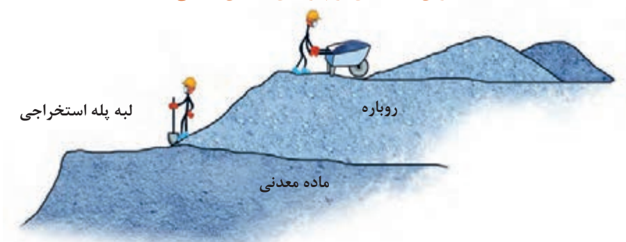
نحوه برداشت روباره در معادن روباز
