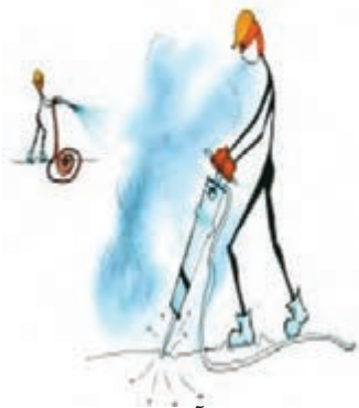
استفاده از اسپری آب جهت کاهش گردوغبار
