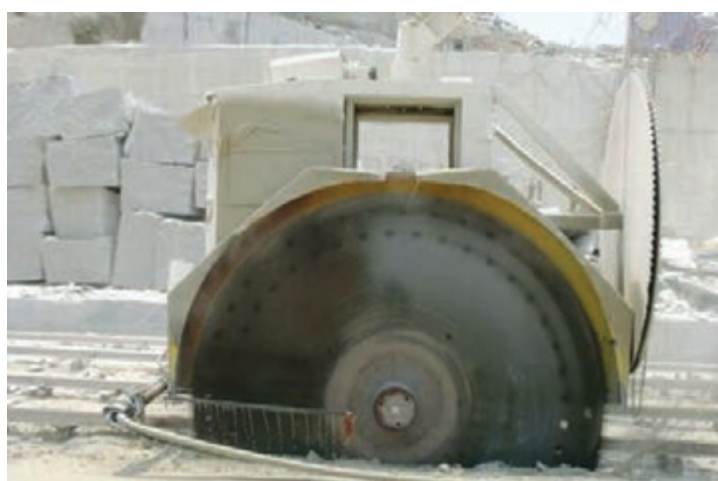
دستگاه دیسک برنده در حال برش سنگ
