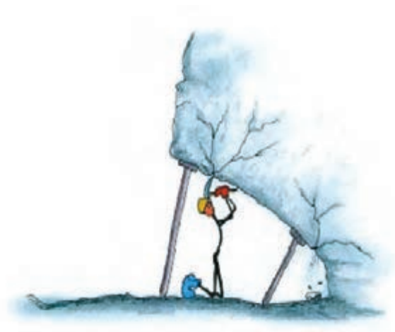
ایجاد زیر برش با نصب وسیله نگهدارنده
