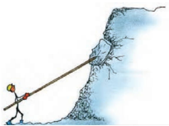
لق‌گیری با چوب بلند و از پایین
