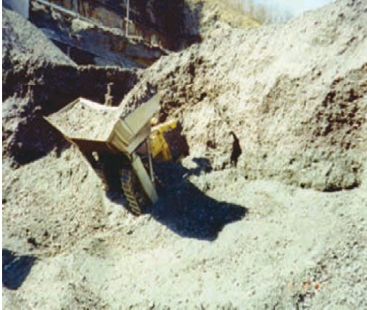
ریزش خاک‌های نرم بر روی ماشین معدنی
