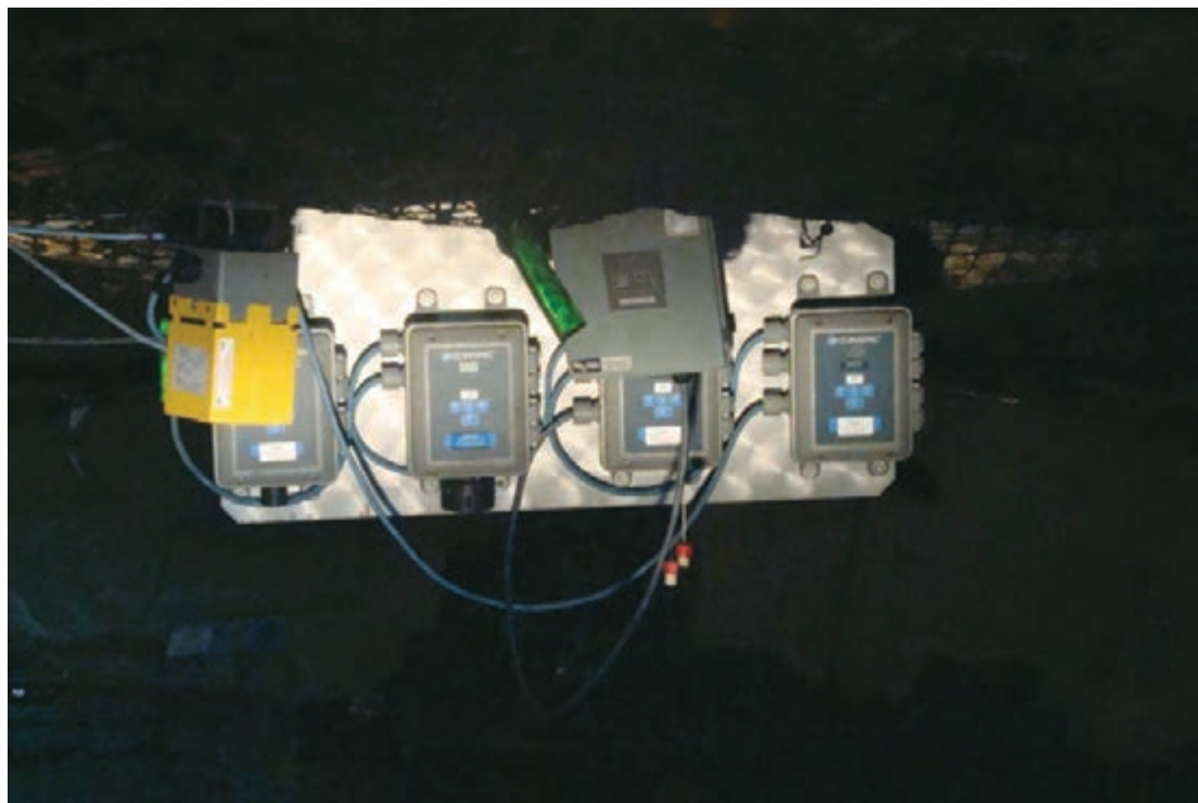
گازسنج‌های دائمی در سینه کار معدن
