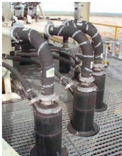
شکل ۲۲- جت‌های تزریق پالپ در سلول فلوتاسیون جیمسون
