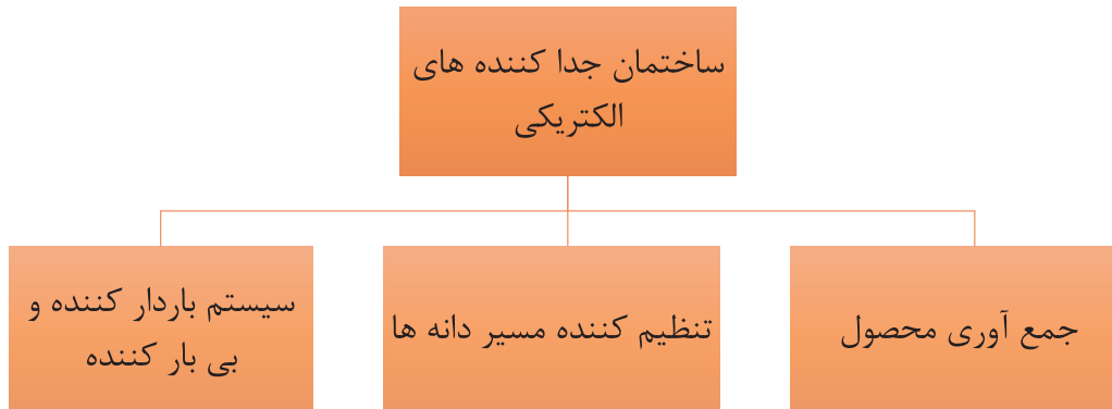
شکل ۳۷- ساختمان جداکننده‌های الکتریکی
