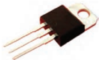
زوج دارلینگتون در یک بسته بندی
