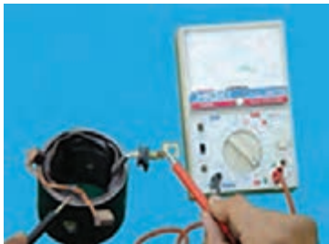
– آزمایش اتصال بدنه بالشتک ها
