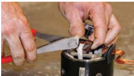
شکل ۹۹ – برخی نکات لحیم کاری زغال های استارتر
