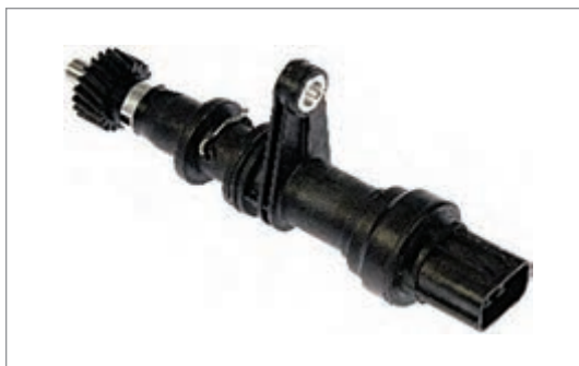
شکل ۱۶- حسگر سرعت خودرو از نوع القایی
