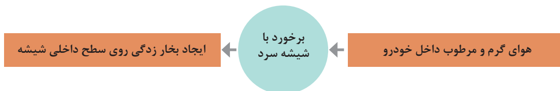
شکل ۳۲- فرایند بخار زدگی شیشه‌ها
