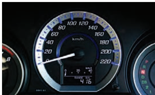
شکل ۲- نشان دهنده از نوع الکترومکانیکی
