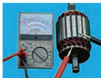
– آزمایش اتصال بدنه آرمیچر
