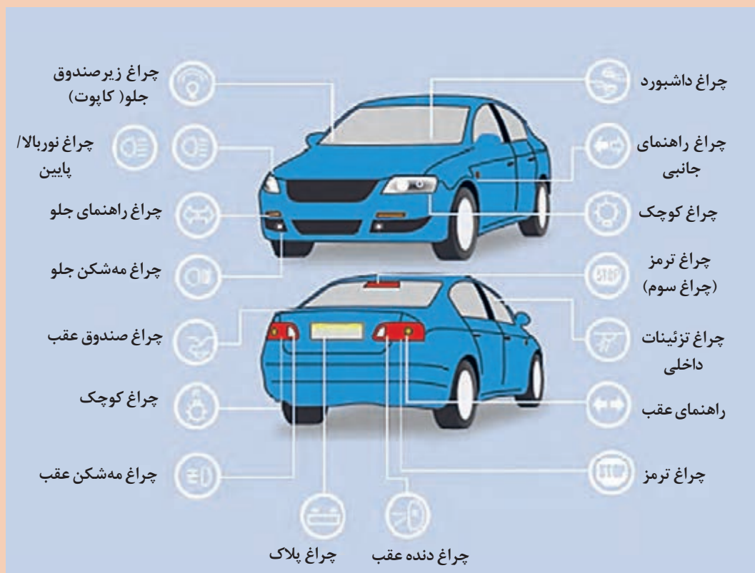
شکل ۳- محل قرارگیری چراغ‌های روشنایی خودرو
