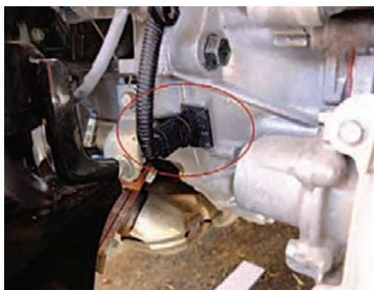
شکل ۱۸- حسگر دور موتور و محل بستن آن
