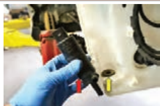
شکل ۳۰- مراحل تعویض پمپ شیشه شوی
