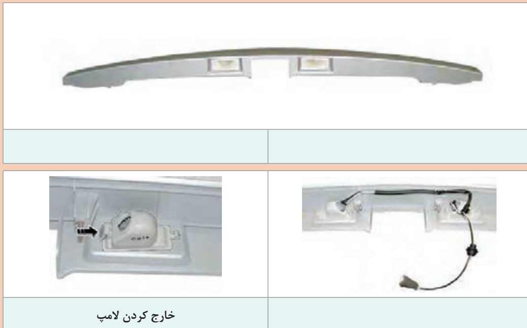
شکل ۳۵- روش باز کردن و بستن چراغ پلاک
