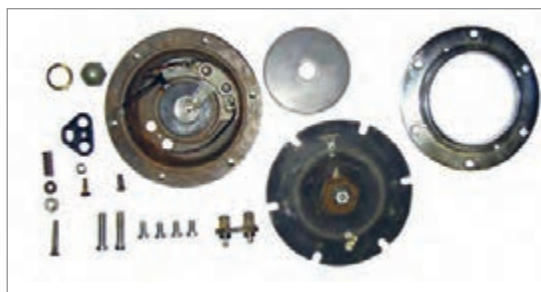
شکل ۴۵- اجزای داخلی بوق الکترومغناطیسی
