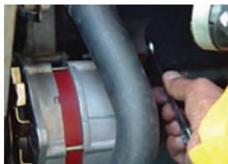
باز کردن پیچ‌های پایه آلترناتور
