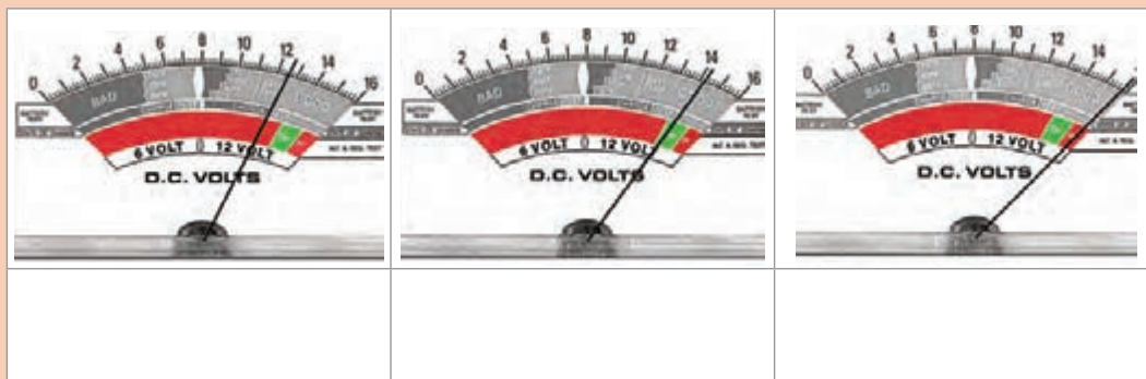
شکل ۷۳- آزمایش زیر بار سیستم شارژ
