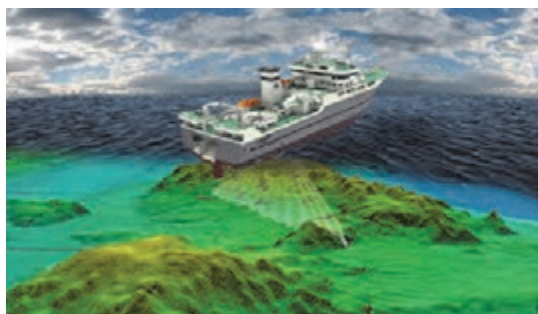
شکل ۱۲- دید ۳۶۰ درجه، آشکارسازی و تصویربرداری کف آب به وسیله دستگاه سونار
