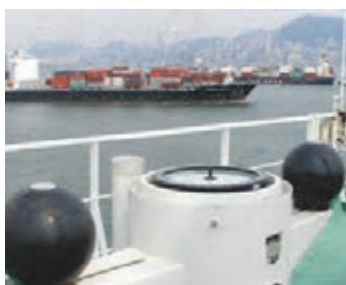
شکل ۲- پایه و گوی‌های تنظیم‌کننده قطب‌نما
