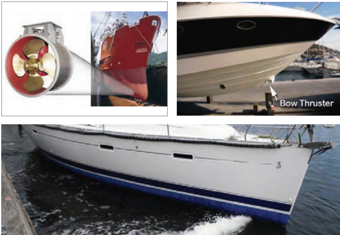
شکل ۶- پروانه‌های جانبی سینه شناور (Bow Thruster)
