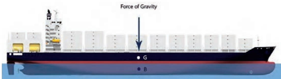
شکل ۶- مرکز ثقل یک شناور
