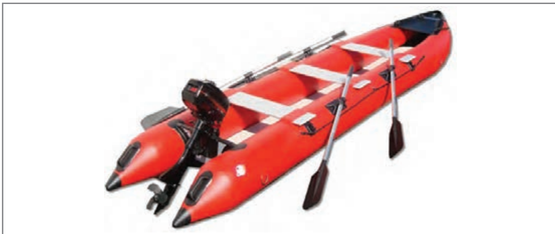
شکل ۱- استفاده از پارو به عنوان پشتیبان در هنگام از کار افتادن موتور قایق نجات
