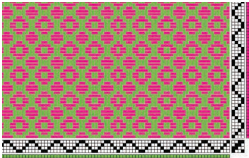
شکل ۲۷: طرح پایه سرژه ۲ و ۲ با نخ کشی و نقشه تکرار پودی جناقی
