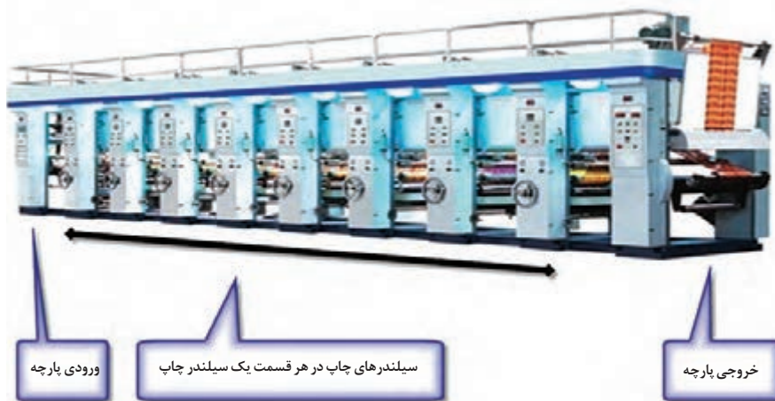
شکل ۸- نمای عملکرد ماشین چاپ غلتکی افقی
