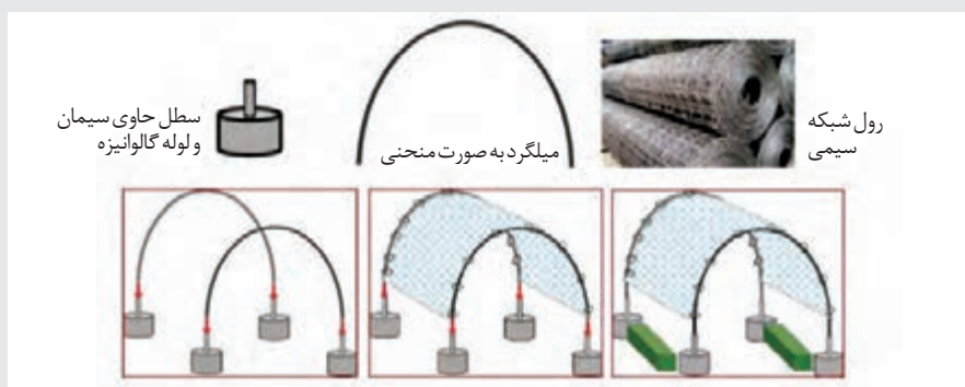
مراحل ساخت تونل سبز توسط شبکه‌های سیمی
