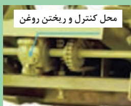
شکل ۶۷- جعبه دنده دوکفه‌ای
