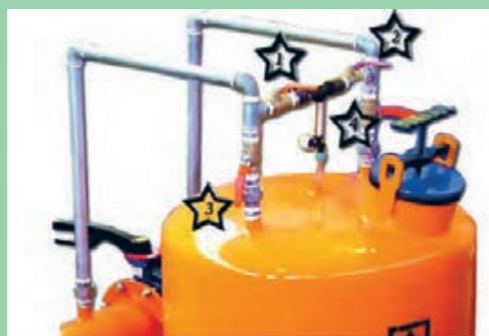
شکل ۳۲- اتصال مخزن کود به لوله اصلی ۱ و ۲- شیرهای برگشت (By pass)، ۳ و ۴- شیرهای ورودی و خروجی مخزن ۵- شیر فلکه روی لوله اصلی
