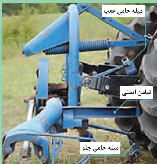
شکل ۲۱- نحوه اتصال دروگر شانه‌ای به تراکتور
