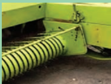
شکل ۲۰- تنظیم ارتفاع بردارنده
