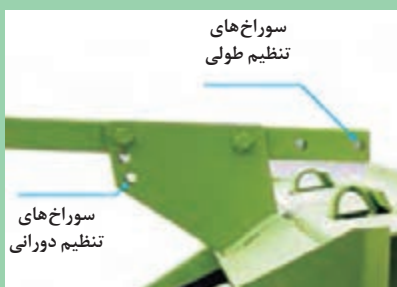
شکل ۵۱- هدایت کننده علوفه و پیچ‌های تنظیم آن
