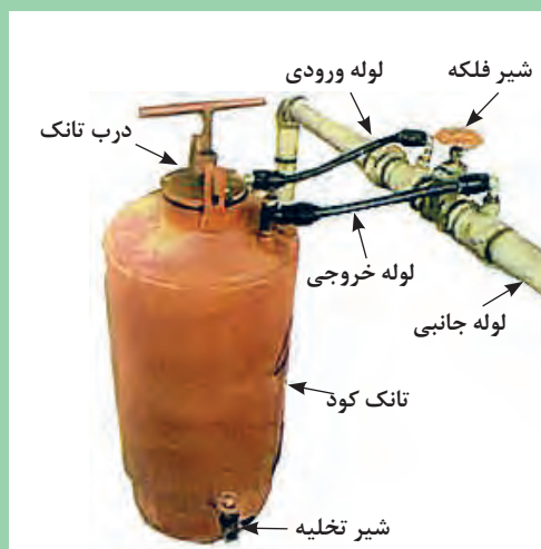
شکل ۳۳- اجزای سیستم توزیع کود
