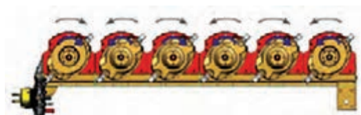
شکل ۸- جهت چرخش بشقاب‌ها در دروگر بشقابی
