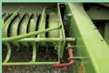
شکل ۱۵- پین نگهدارنده بردارنده
