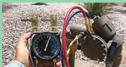
شکل ۱۷- تنظیم فشار شیر فشارشکن
