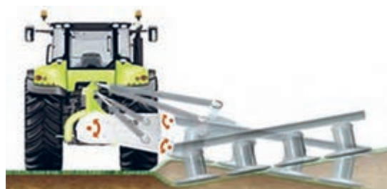
شکل ۱۲- حالت‌های کاری دروگر استوانه‌ای در شیب
