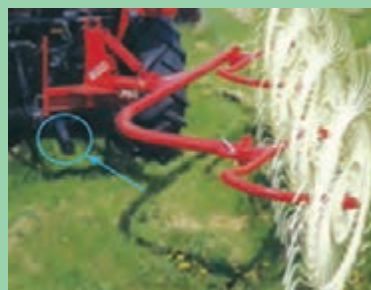
شکل ۹- اتصال شانه خورشیدی به تراکتور
