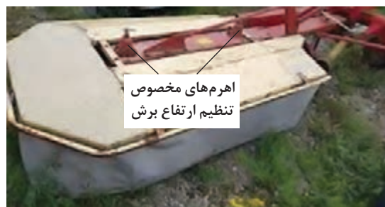
شکل ۲۸- اهرم‌های مخصوص تنظیم ارتفاع برش
