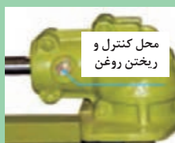
شکل ۶۶- جعبه دنده زانویی تیغه درو
