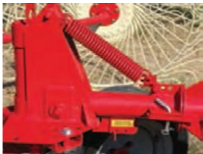
شکل ۱۰- فنرهای شناوری
