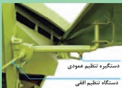
شکل ۵۰- دستگیره‌های تنظیم صفحه جداکننده محافظ علوفه
