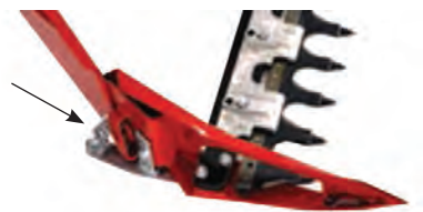
شکل ۳۱- کفشک تنظیم ارتفاع برش
