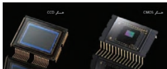
▲ تصویر ۱۰ | حسگر CCD و CMOS
