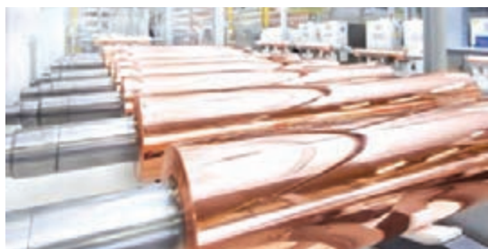
شکل ۵- سیلندر آبکاری شده با فلز مس
