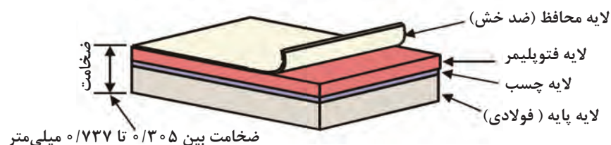
شکل ۵- لایه‌های کلیشه فتوپلیمر
