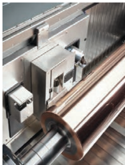
شکل ۶۷- قرارگیری لیزر در محل شروع حکاکی
