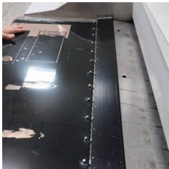
شکل ۳۸- نصب کلیشه توسط پانچ بر روی دستگاه شست‌وشو
