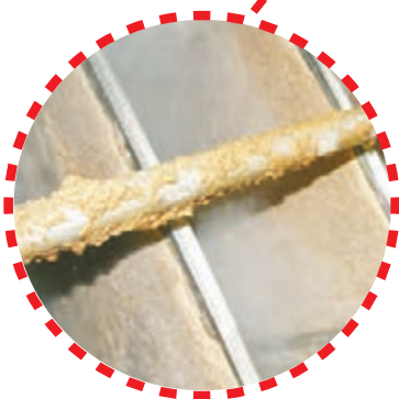
غلتک آهنی برای صاف کردن خمیر کاغذ
