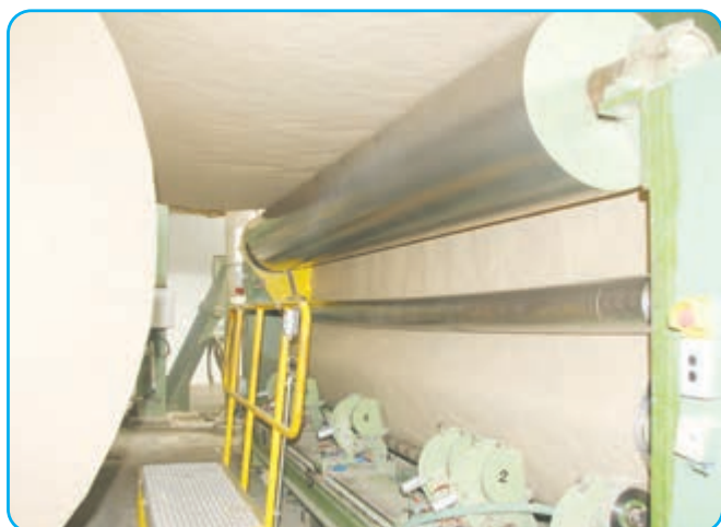
غلتک آهنی برای صاف کردن خمیر کاغذ
