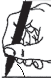
شکل ۳-۱۳ زاویه ی قلم کمتر از ۸۰ درجه نباشد.
