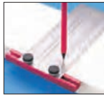
شکل ۱-۳۴ قرقه‌های متصل کننده‌ی خط کش به میز
