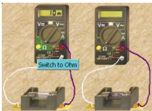
شکل ۸۱-۲ اتصال فیوز به اهم متر
