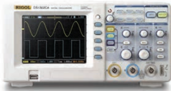
شکل ۲-۱۳۲- اسیلوسکوپ دو کاناله دیجیتال. اسیلوسکوپ دو کاناله می‌تواند و شکل موج را به‌طور هم‌زمان روی نمایش‌گر نشان دهد.
