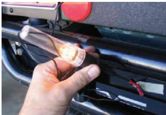
شکل ۸۶-۲ - استفاده از تستر لامپی
