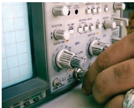
شکل ۱۱۴-۲ نحوه‌ی اتصال BNC به اسیلوسکوپ
