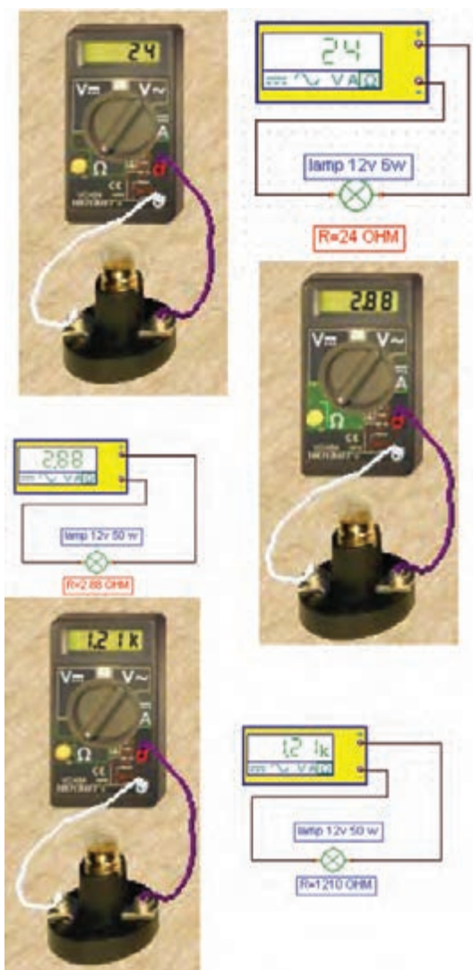
شکل ۸۹-۲ اندازه گیری مقاومت لامپ‌های روشنایی
