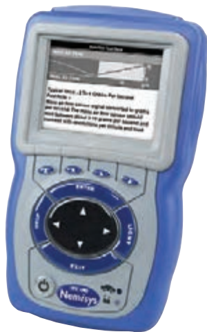
شکل ۲-۱۳۳- یک نمونه دستگاه اسکنر (scanner) خودرو را نشان می‌دهد، که در آن از اسیلوسکوپ استفاده شده است.
