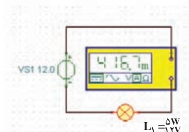
شکل ۲-۹۴- اندازه گیری جریان یک لامپ ۱۲ ولتی ۵ وات
