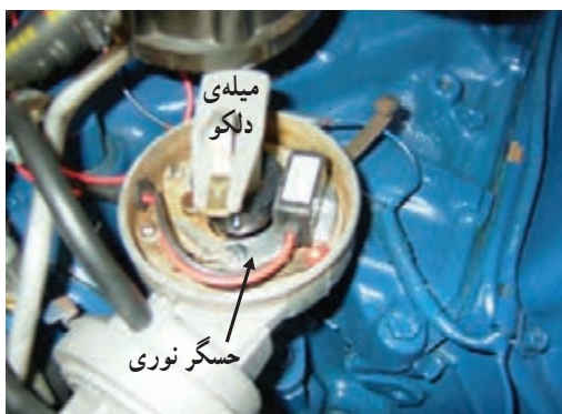
شکل ۱۴۵-۲ سه نمونه حسگر استفاده شده در سیستم جرقه زنی
