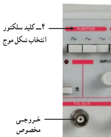
شکل ۲-۱۰۱ کلید سلکتور انتخاب شکل موج
