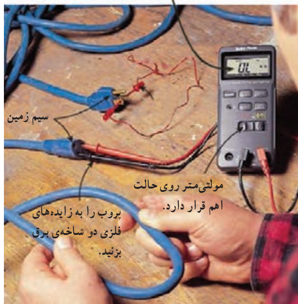
شکل ۲-۸۰ — آزمایش سیم رابط برق دستگاه.
