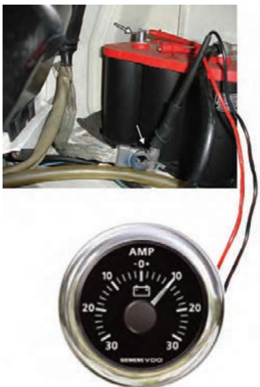
شکل ۱-۵۲ اتصال آمپر متر به صورت سری
