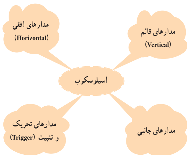
شکل ۱۲۰-۲- مدارهای موجود در اسیلوسکوپ
