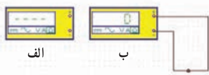
شکل ۲-۷۹ — آزمایش اطمینان از سلامت اهم متر
